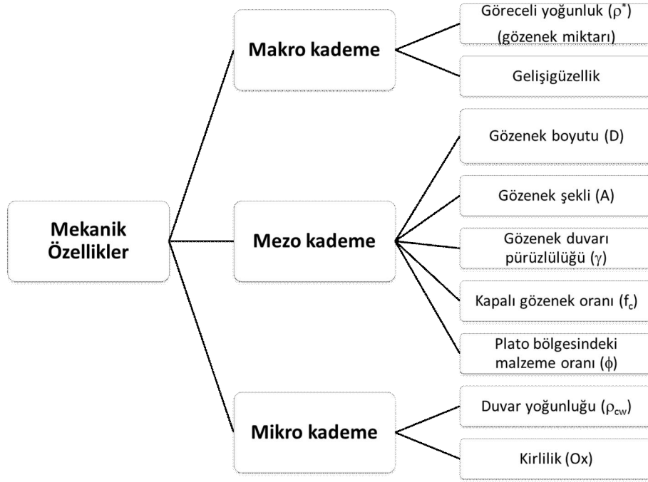
Şekil 9.2. Titanyum köpüklerde mekanik özellikler üzerinde etken olan yapısal değişkenlerin hiyerarşik gösterimi
