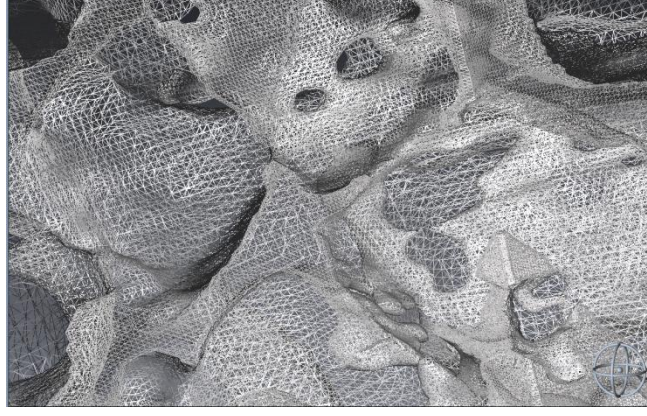
Şekil 7.16. Bu çalışmada üretilen köpüklerin üç boyutlu görüntülerinin elde edilmesi için uygulanan üçgenleştirme görüntüsü
