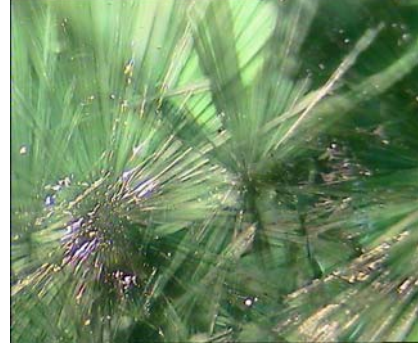
Şekil 5.20. KS Atık CuO içerikli elenmemiş numunenin stereo mikroskop görüntüsü
