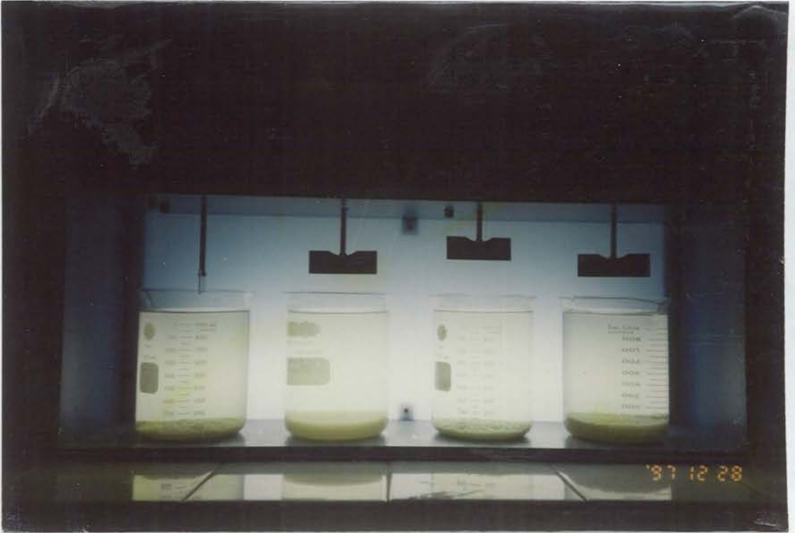
Şekil 8.4. Alüminyum sülfat ile yapılan çöktürme: Çöktürme sonrasındaki görüntü
