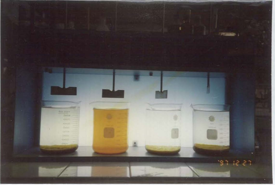
Şekil 8.3. Demir 3 klorür ile yapılan çöktürme: Çöktürme sonrasındaki görüntü
