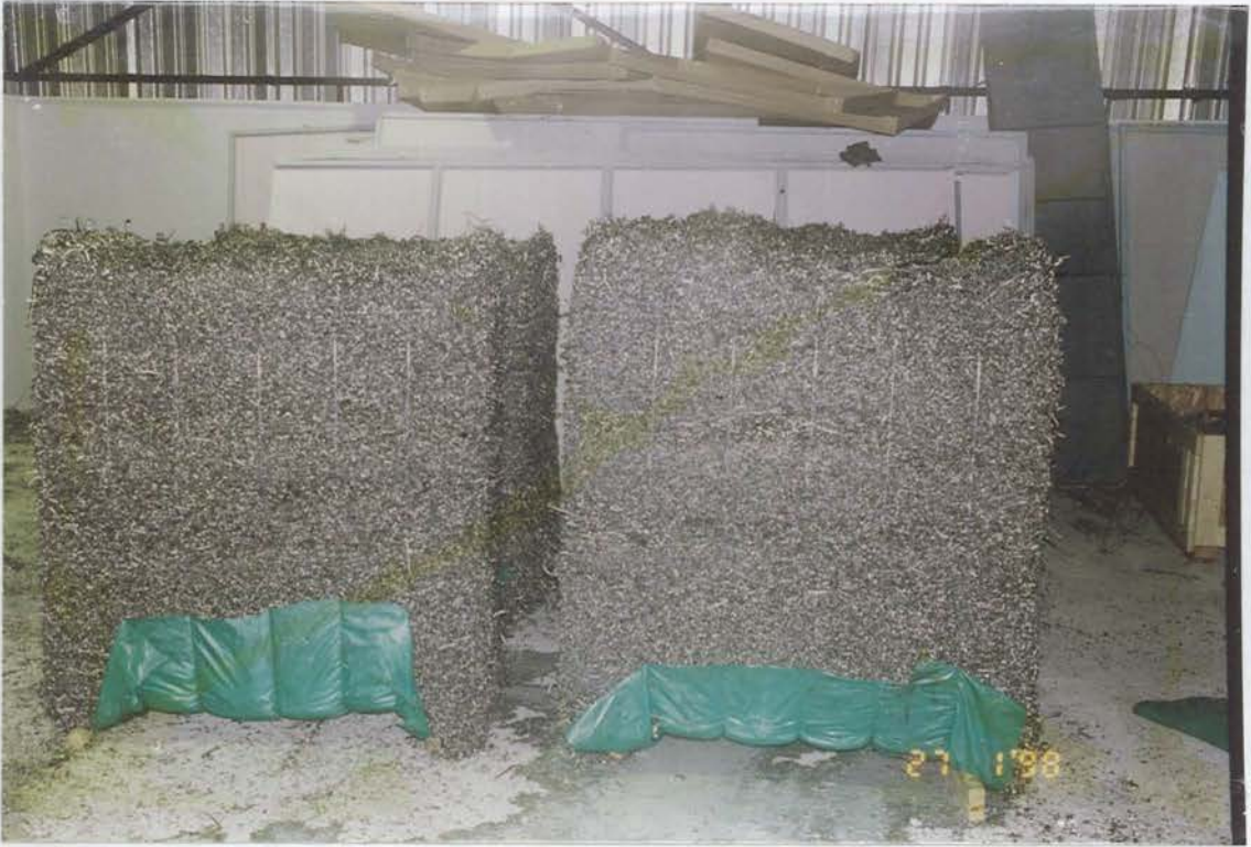
Şekil EK 2.2. TEI' de preslenip hacmi azaltılmış talaşlar.
