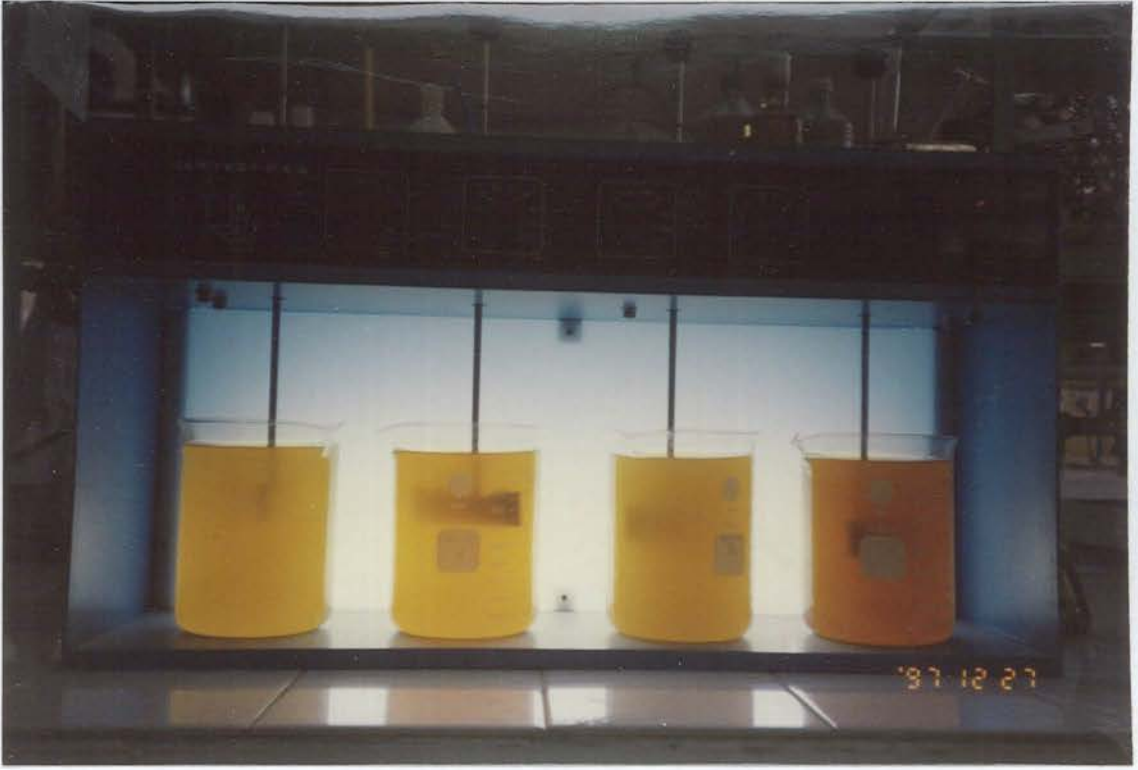
Şekil 8.1. Demir 3 klorür ile yapılan çöktürme: Yavaş karıştırma anında görüntü
