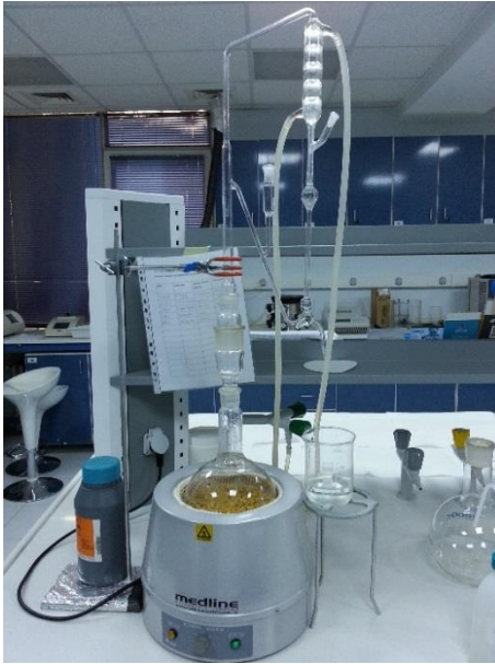
Görsel 3.4. Clevenger apareyinde hidrodistilasyon işlemi (Foto: Yelbaşı, 2019 )
