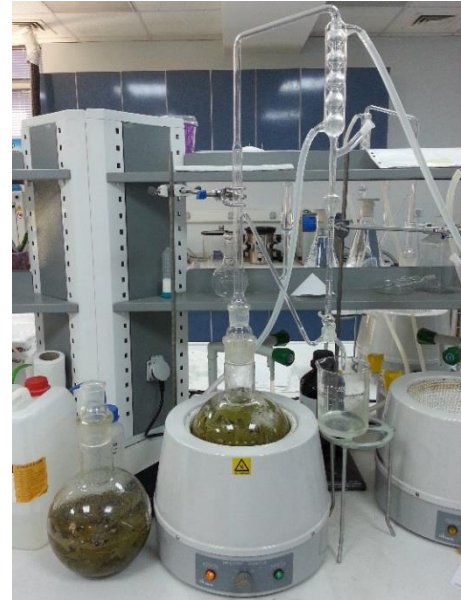
Görsel 3.4. Clevenger apareyinde hidrodistilasyon işlemi (Foto: Yelbaşı, 2019 )
