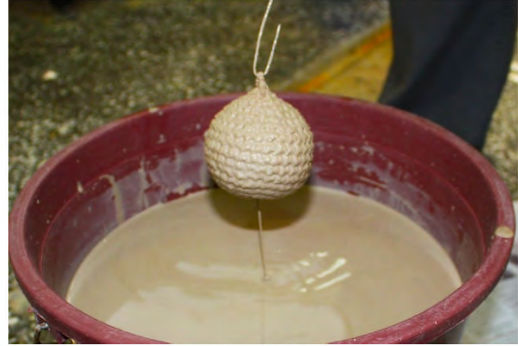
Görsel 262, 263, 264 Deneme Formu Üzerinde Katman Uygulanışı
