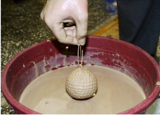
Görsel 262, 263, 264 Deneme Formu Üzerinde Katman Uygulanışı
