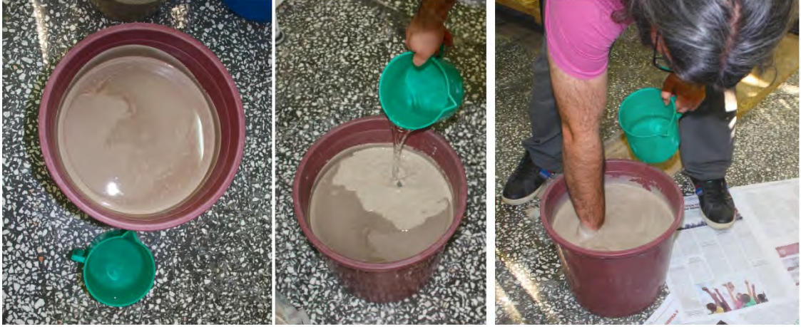
Görsel 253, 254, 255 Kullanılacak Döküm Çamurunun Seyreltilerek Hazırlanması
