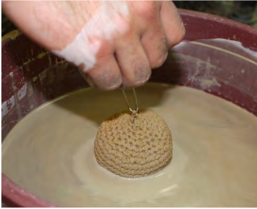
Görsel 256, 257, 258, 259, 260, 261 Deneme Formu Üzerinde İlk Katmanın Uygulanışı
