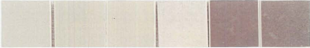
Şekil 4.12. 1250 °C'de kalsine edilen sırası ile B 1 Mn 5 , B 1 Mn 10 , B 1 Mn 15 , B 6 Mn 10 , BMn 10 ve BMn 20 kodlu pigmentlerin duvar karosu şeffaf sırda oluşturduğu renkler.
