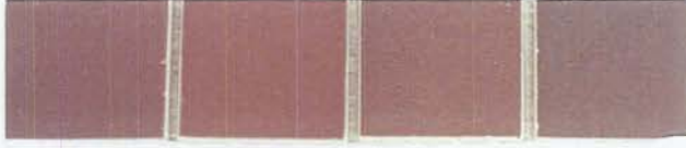
Şekil 4.6. 1250 °C’de kalsine edilen sırası ile A 1 , A 2 , A 3 ve A 4 kodlu pigmentlerin duvar karosu şeffaf sırda oluşturduğu renkler.
