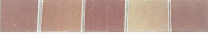
Şekil 4.25. 1250 °C' de kalsine edilen sırası ile D_1 , D_2 , D_3 , D_4 ve D_5 kodlu pigmentlerin duvar karosu şeffaf sırda oluşturduğu renkler.
