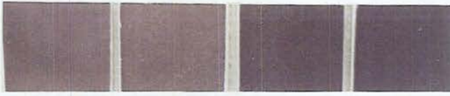
Şekil 4.34. 1250 °C' de kalsine edilen sırası ile E 1 Co 5 , E 1 Co 10 , E 1 Co 20 ve E 1 Co 30 kodlu pigmentlerin duvar karosu şeffaf sırda oluşturduğu renkler.
