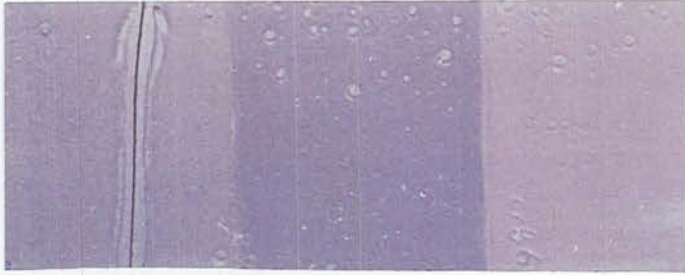
Şekil 4.41. 1250 °C' de kalsine edilen sırası ile B_1Cr_{10} , BCr_{20} ve B_6Cr_{10} kodlu pigmentlerin yer karosu saten sırda oluşturduğu renkler.
