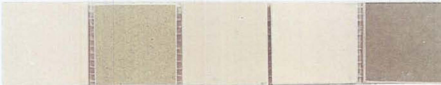
Şekil 4.5. Sırası ile Seydişehir kırmızı çamur atığı, kumlama atığı, Küre konsantre pirit atığı ve Samsun bakır üretimi proses atığının 1250 °C' de kalsine edildikten sonra duvar karosu şeffaf sırada oluşturduğu renkler.
