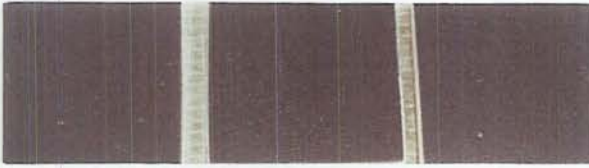
Şekil 4.27. 1250 °C' de kalsine edilen sırası ile D_3Co_{10} , D_3Co_{20} ve D_3Co_{30} kodlu pigmentlerin duvar karosu şeffaf sırda oluşturduğu renkler.
