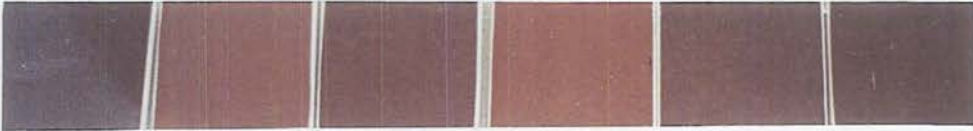
Şekil 4.8. 1250 °C’de kalsine edilen sırası ile A 1 Cr 10 , A 2 Cr 10 , A 1 Cr 20 , A 2 Cr 20 , A 3 Cr 10 ve A 3 Cr 20 kodlu pigmentlerin duvar karosu şeffaf sırda oluşturduğu renkler.
