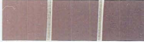
Şekil 4.33. 1250 °C' de kalsine edilen sırası ile E 1 , E 2 , ve E 3 kodlu pigmentlerin duvar karosu şeffaf sırda oluşturduğu renkler.
