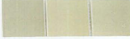
Şekil 4.17. 1250 °C'de kalsine edilen sırası ile C 1 , C 2 ve C 3 kodlu pigmentlerin duvar kerosu şeffaf sırda oluşturduğu renkler.
