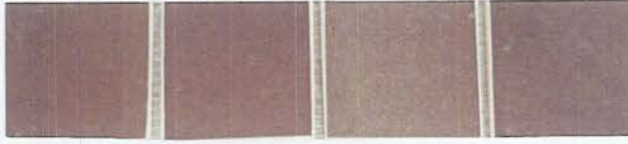
Şekil 4.29. 1250 °C' de kalsine edilen sırası ile D_1Mn_{10} , D_1Mn_{20} , DMn_{10} ve DMn_{20} kodlu pigmentlerin duvar karosu şeffaf sırda oluşturduğu renkler.
