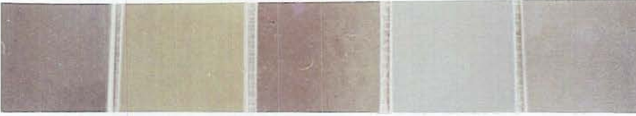
Şekil 4.26. 1250 °C' de kalsine edilen sırası ile D_1Co_{10} , D_2Co_{10} , D_3Co_{10} , D_4Co_{10} ve D_5Co_{10} kodlu pigmentlerin duvar karosu şeffaf sırda oluşturduğu renkler.
