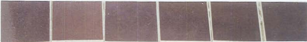
Şekil 4.9. 1250 °C’de kalsine edilen sırası ile A 1 Mn 10 , A 2 Mn 10 , A 1 Mn 20 , A 2 Mn 20 , A 3 Mn 10 ve A 3 Mn 20 pigmentlerin duvar karosu şeffaf sırda oluşturduğu renkler.
