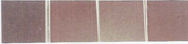
Şekil 4.19. 1250 °C'de kalsine edilen sırası ile C 4 Cr 10 , C 1 Cr 10 , CCr 10 ve CCr 20 kodlu pigmentlerin duvar kerosu şeffaf sırda oluşturduğu renkler.
