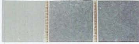
Şekil 4.18. 1250 °C'de kalsine edilen sırası ile C 2 Co 5 , C 2 Co 10 ve C 2 Co 15 kodlu pigmentlerin duvar kerosu şeffaf sırda oluşturduğu renkler.
