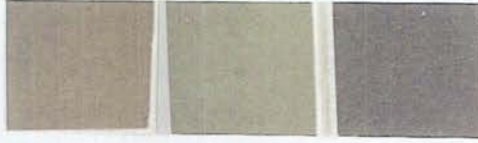
Şekil 4.7. 1250 °C’de kalsine edilen sırası ile A 1 Co 10 , A 2 Co 5 ve A 2 Co 15 kodlu pigmentlerin duvar karosu şeffaf sırda oluşturduğu renkler.
