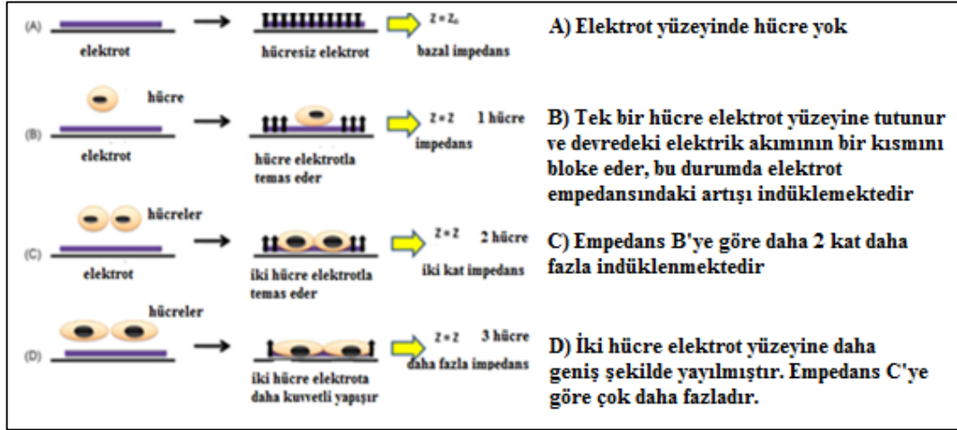
Şekil 2.3. Empedans ölçüm şeması (Urcan ve ark., 2010)
