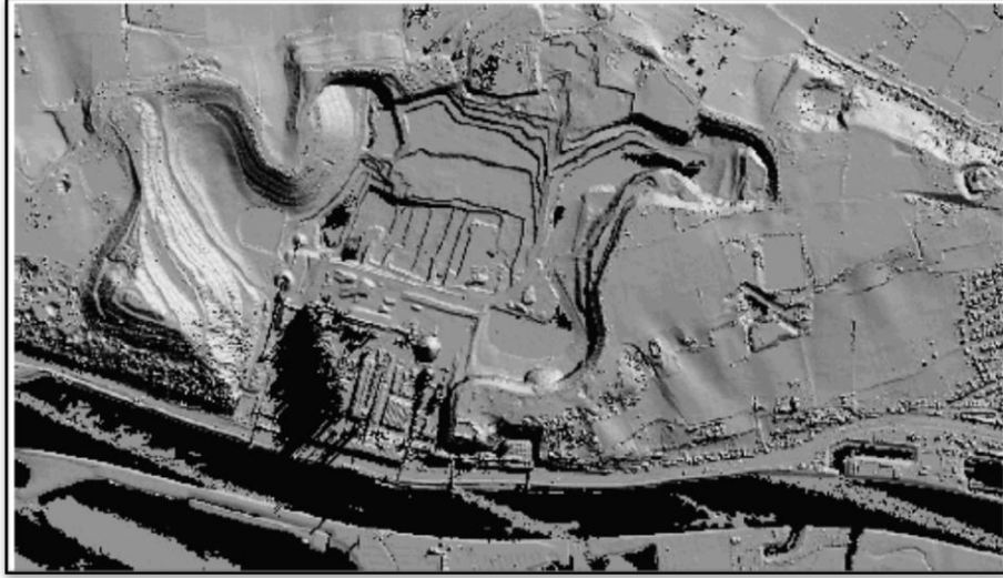
Şekil 2.19. Hollanda, Sint Pietersberg’de bulunan açık maden ocağının sayısal yüzey modelinin resimli gösterimi. Ocak kabaca 1 km’ye 2 km boyutlarındadır. Ocağın terasının kenarı açıkça görünür biçimdedir. Görüntünün alt kısmının yakınındaki siyah şerit Maas nehridir. Rijkswaterstaat anket bölümünün müsadesi ile (Bakker ve ark. 2009)
