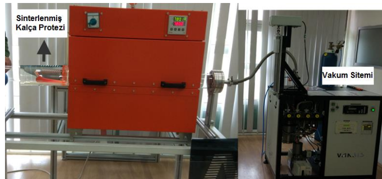
Şekil 4.8. Kalça protezinin sinterleme sürecinde kullanılan tüp fırın ve vakum sistemi
