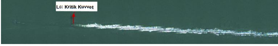
Şekil 3.35. 50W plazmaya maruz kalmış kapalama yüzeyinde oluşturulan çiziklin optik görüntüsü
