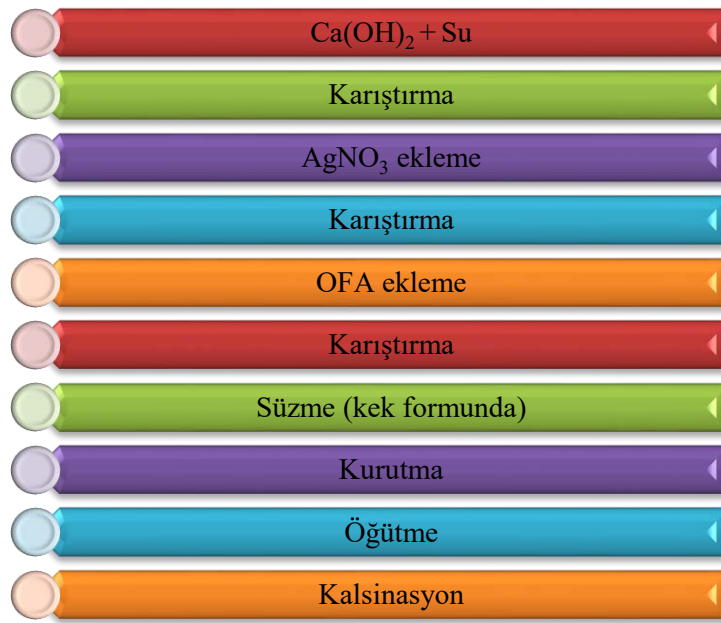
Şekil 2.12. Antibakteriyel kalsiyum fosfat esaslı toz üretim akım şeması
