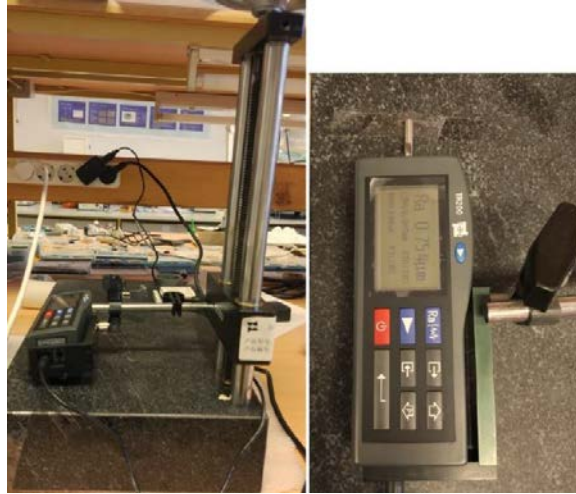
Şekil 3.24. TESKOM TR200 yüzey pürüzlülük ölçüm cihazı
