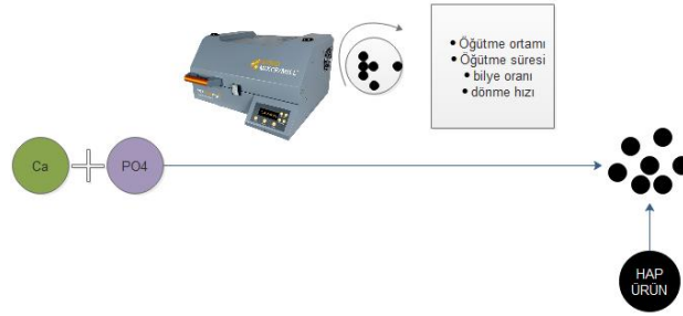
Şekil 2.2. Mekanokimyasal yöntem ile HAP eldesi
