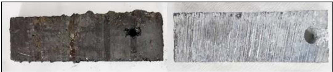
Görsel 2. 10. Yapay sulak alan ekolojik yakıt hücresi modüllerinde kullanılan anot (2 cmx8 cmx0,5 cm) ve katot elektrotları (2 cmx8 cmx1 cm)
