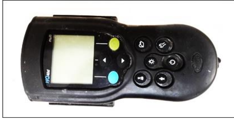
Görsel 2. 25. Taşınabilir çoklu su ölçüm cihazı (HACH HQ40D Multi-Parameter Taşınabilir pH Metre)
