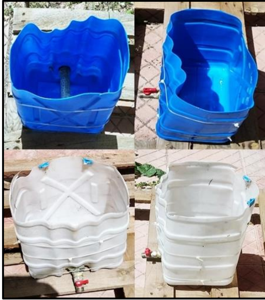
Görsel 2. 3. Yapay sulak alan ekolojik yakıt hücresi modüllerinin kurulacağı polyester düzenekler (45 cm×45 cm×40cm)
