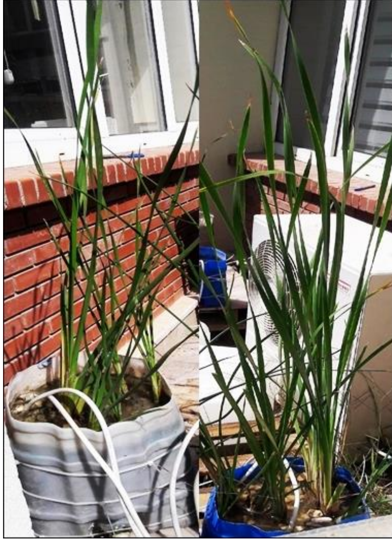
Görsel 2. 20. Kültür periyodu sonrasında Typha angustifolia bitkisine sahip yapay sulak alan ekolojik yakıt hücresi 2 (YSA-EYH 2)
