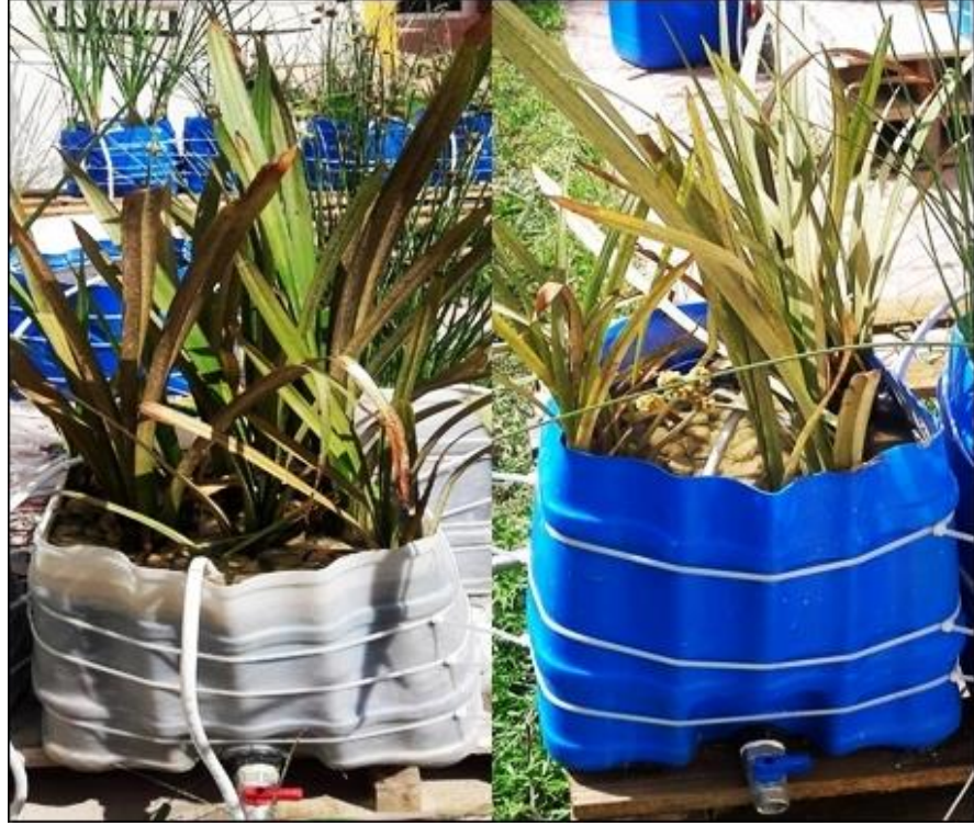
Görsel 2. 21. Kültür periyodu sonrasında Typha latifolia bitkisine sahip yapay sulak alan ekolojik yakıt hücresi 3 (YSA-EYH 3)
