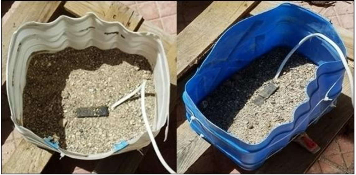
Görsel 2. 9. Yapay sulak alan ekolojik yakıt hücresi modüllerine anot elektrotlarının yerleştirilmesi
