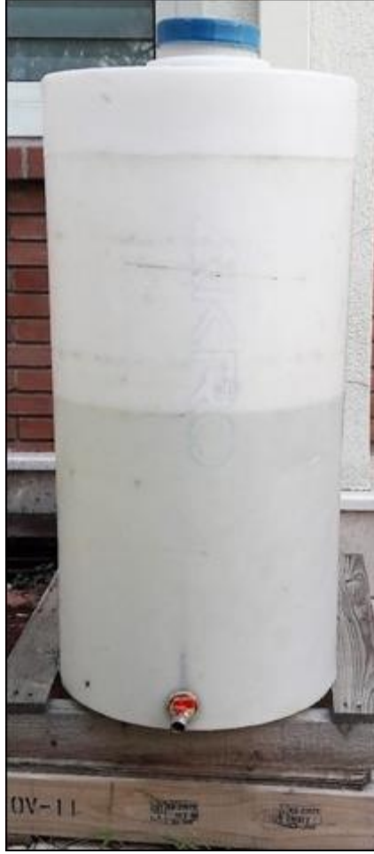
Görsel 2. 4. Sentetik Atık suyun hazırlandığı su tankı (100 L)
