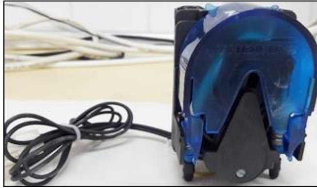
Görsel 2. 5. Sentetik atık suların modüllere verilmesini sağlayan peristaltik pompa
