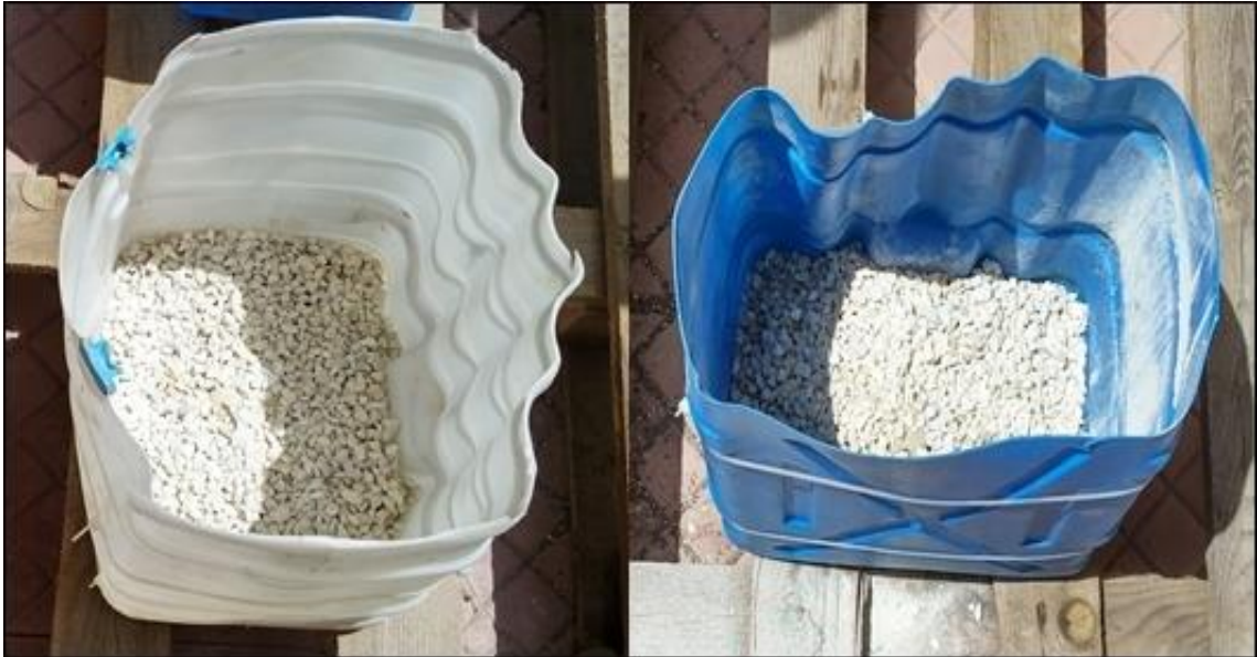
Görsel 2. 7. Yapay sulak alan ekolojik yakıt hücresi modüllerine çakıl taşlarının yerleştirilmesi
