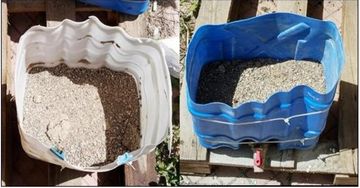
Görsel 2. 8. Yapay sulak alan ekolojik yakıt hücresi modüllerine anot katmanının dolgu malzemesinin yerleştirilmesi
