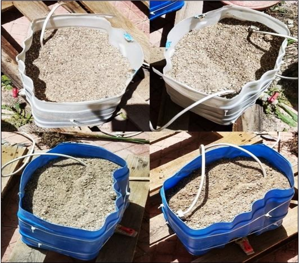
Görsel 2. 12. Yapay sulak alan ekolojik yakıt hücresi modüllerinde katot katmanının dolgu malzemesinin oluşturulması ve katot elektrotlarının yerleştirilmesi
