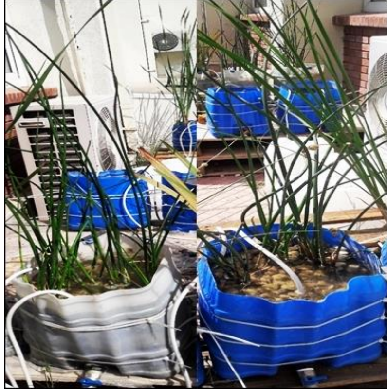
Görsel 2. 22. Kültür periyodu sonrasında Carex divisa bitkisine sahip yapay sulak alan ekolojik yakıt hücresi 4 (YSA-EYH 4)
