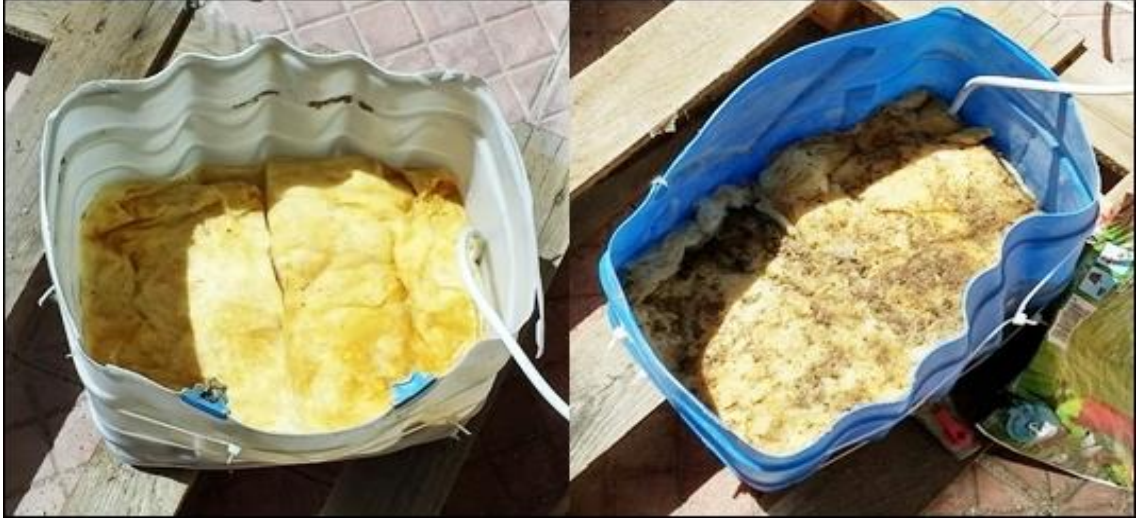
Görsel 2. 11. Yapay sulak alan ekolojik yakıt hücresi modüllerinde kullanılan cam yününün yerleştirilmesi
