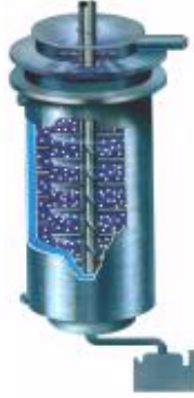
Şekil 4.13. Sürekli atritörlerin şematik gösterimi (Shilling,2000)
