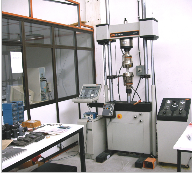
Şekil 6.9. Çekme, basma ve yorulma testlerinin yapıldığı Intsron test cihazı
