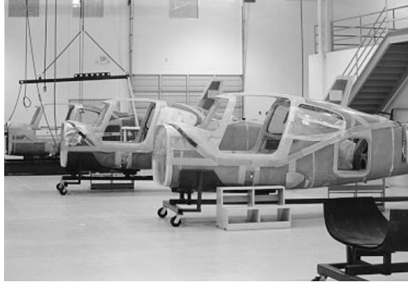
Şekil 3.5. Cirrus SR20 uçağının cam takviyeli plastikten yapılan gövdesi [28]
