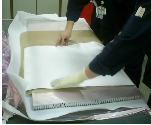
Şekil 6.2. Kalıp, yardımcı parçalar ve reçine ile ıslanmış karbon elyaf kumaşların belirli bir sırada yerleştirilmesi
