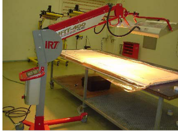
Şekil 6.4. Otomatik sıcaklık kontrolüne sahip ısı lambaları ile kür işlemi
