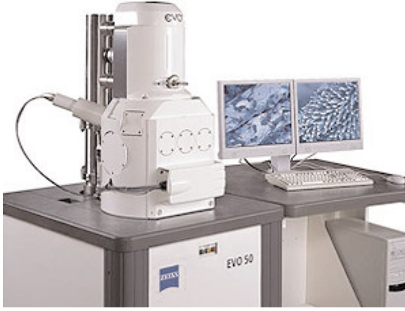
Şekil 6.11. Kırılmış veya hasarlı numunelerin mikroskobik incelemelerinde kullanılan taramalı elektron mikroskobu (ZEISS EVO 50)
