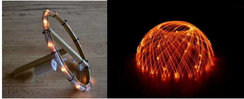
Görsel 2.14. Çember şeklinde bir düzeneğe monte edilmiş LED şerit ve bu şeridin kendi etrafında döndürülmesiyle elde edilmiş geometrik şekil
