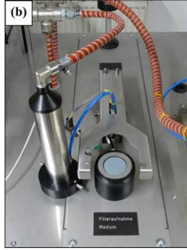
Şekil 4.2. (a) Basınç kaybı ve PM yükleme test düzeneği, (b) disk numune tutucu
