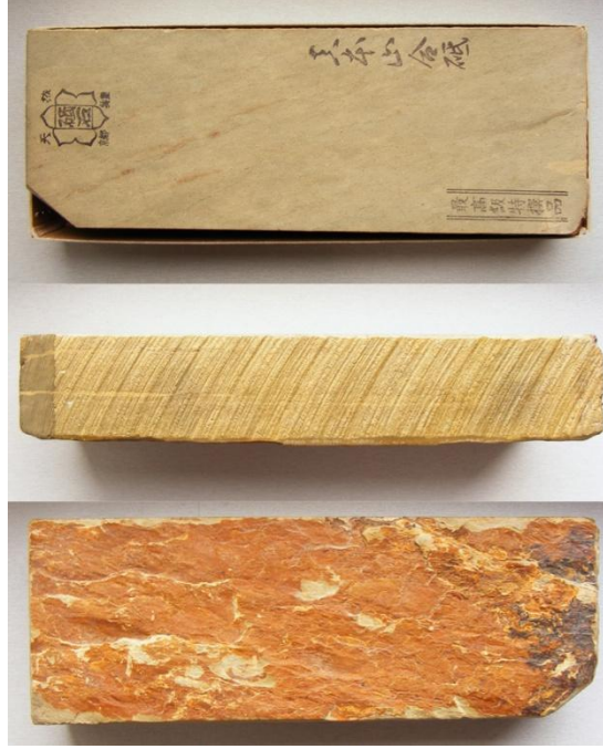
Resim 7. Nakayama Madeninden Çıkarılmış Bir Doğal Japon Su Taşı 60
