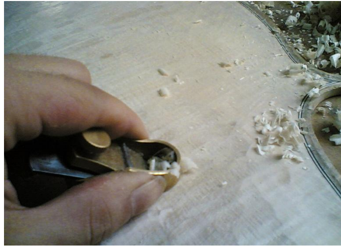
Resim 30. Parmak Rende ile Bir Çello Kapağının Ölçeklendirilmesi
