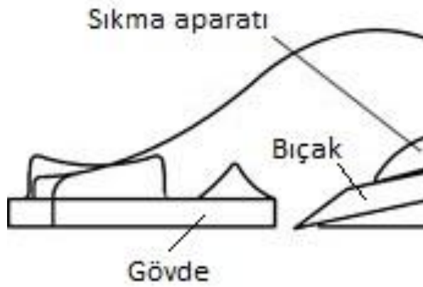
Şekil 26. Standart Bir Avuç Rendesinde Kesici Çelik Yerleşimi
