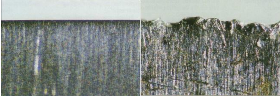
Resim 34. Mikroskop altında bir ıskarpelanın kesici yüzeyi. Solda keskin, sağda körelmiş bir kesici yüzey
