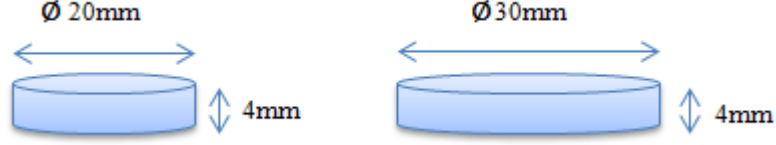
Şekil 5.3. 20 ve 30mm çapında ve 4mm kalınlığında hazırlanan numuneler
