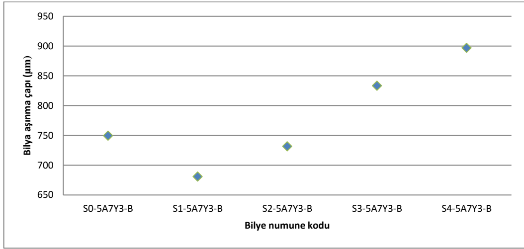
Şekil 6.110. Aşınma testinde kullanılan bilyelerin aşınma çapı
