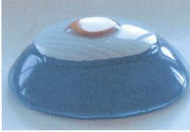
Resim 36. Seramik formla fırında birleştirilmek üzere hazırlanmış cam parça
