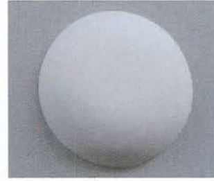
Resim 37. Cam parça için hazırlanmış refrakter kalıp
