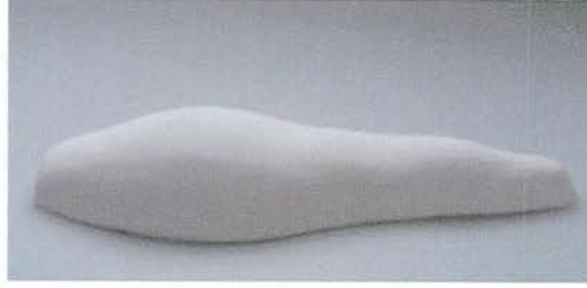
Resim 18. Kuvartz alçı karışımı refrakter malzemenen şekillendirilmiş kalıp
