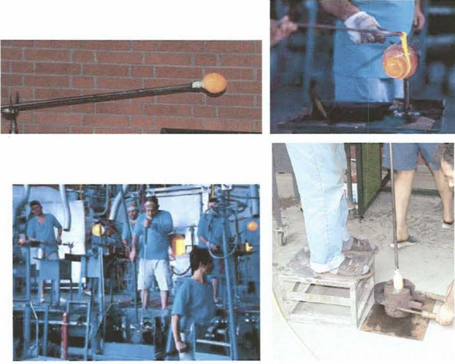
Resim 27. Üfleyerek şişirme işleminin bazı aşamaları
