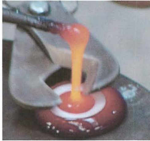
Resim 25. Sıcak camı ezerek delme yönteminin bazı aşamaları
