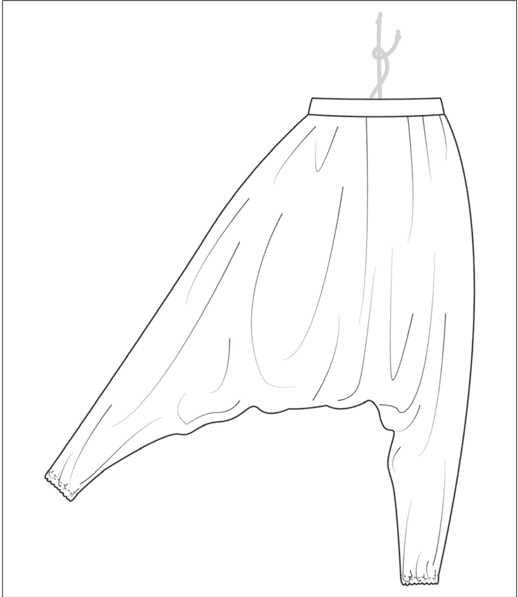
Şekil 4.23. Şalvar teknik çizimi; arka görünüş
