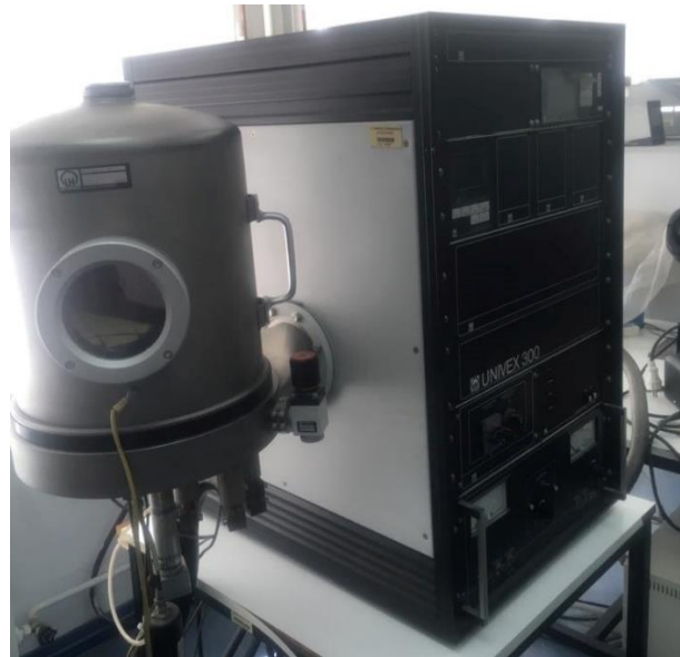
Görsel 4.1. Leybold-Heraus 300 Univex System Au buharlaştırma cihazı
