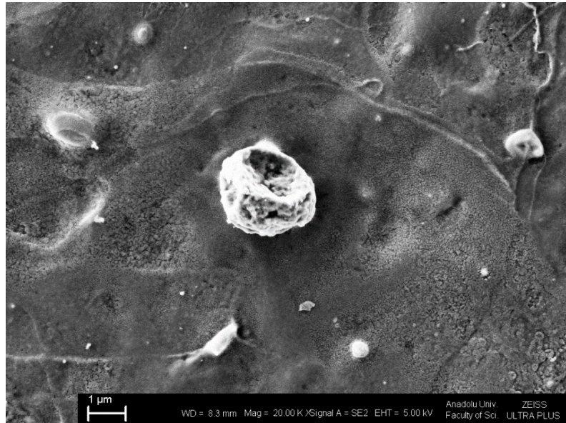
Şekil 5.26. Ultrasonik püskürtme yöntemiyle 300°C taban sıcaklığında FTO taban üzerine üretilen Co 3 O 4 filminin FESEM görüntüsü
