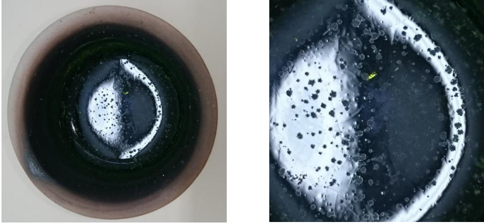
Görsel 4.16. 1150°C'de ve %3 numunede oluşan kristaller.
