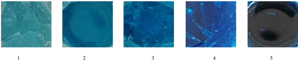
Görsel 4.28. 1150°C'de Bakır(II) oksit (CuO) kullanarak üretilen turkuaz camlar.
