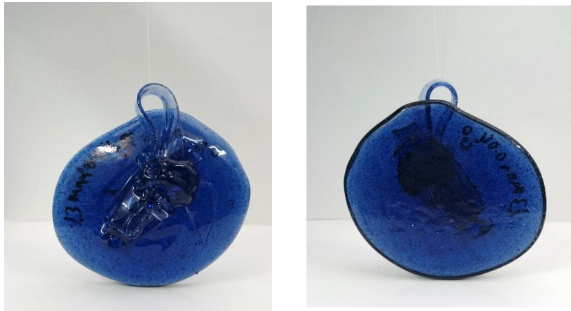
Görsel 5.8. 1200°C'de döküm yapılan koyu morumsu mavi cam ( 3\% \text{MnO}_2 + \%0.01\text{CoO} )
