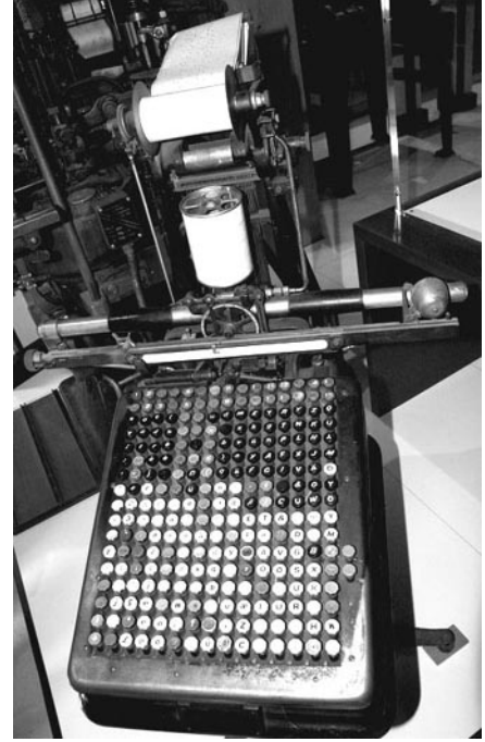
Resim 7. Solda 19. Yüzyılda İcat Edilen Dizgi Makinesi Linotype, Sağda Gutenberg Müzesi'nde Bulunan Dizgi Makinesi Monotype
