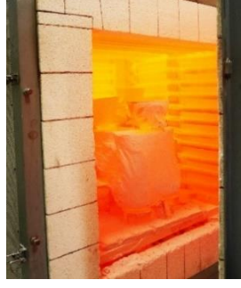
Görsel 3. 14. Fırın içerisindeki refrakter kalın 850 santigrat derecede kontrolü (Murat Paktur fotoğraf arşivi)
