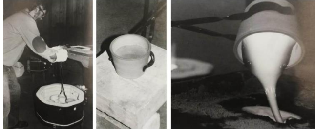
Görsel 1. 24. Fırın içerisinde seramik potada cam eğitme ve refrakter kalıba döküm yöntemi (Lundstrom, 1983, s. 28)
