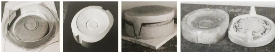
Görsel 1. 11. İki parçalı refrakter kalıp yapımı (Lundstrom, 1983, s. 10)
