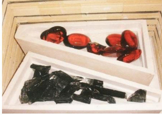
Görsel 1. 33. Cam yüklemesi gerçekleştirilmiş açık kalıp (Baker, 2010, s. 116)
