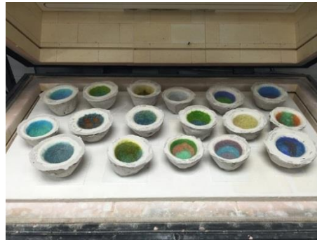
Görsel 1. 13. Pate de verre kalıplarının fırınlanması ( https://www.bullseyeglass.com/kilnforming/basic-pate-de-verre-bowl-bay-area-1642.html )
