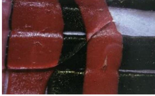
Görsel 2. 21. Tavlama kaynaklı çatlak oluşumu (Baker, 2010, s. 35)
