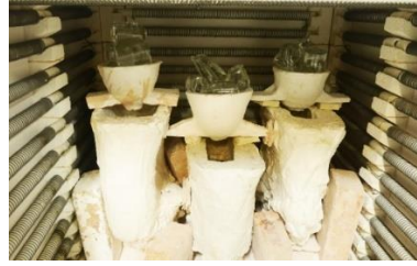
Görsel 1. 20. Potalı akıtma döküm tekniğinde pota kullanımı ve fırınlanması (Murat Paktur fotoğraf arşivi)
