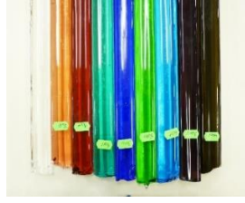
Görsel 3. 1. Fırın içerisinde kalıpta şekillendirmede yaygın olarak tercih edilen Geleneksel Çek Camının cam renkleri (Murat Paktur fotoğraf arşivi)
