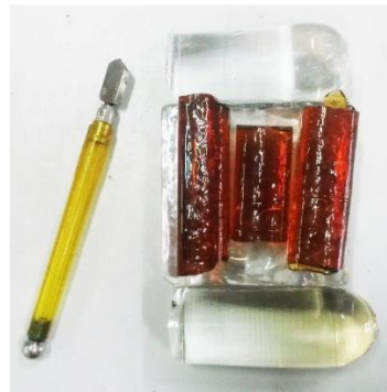
Görsel 3. 13. Kalıp içerisine yerleştirilecek camların hazırlanması (Murat Paktur fotoğraf arşivi)
