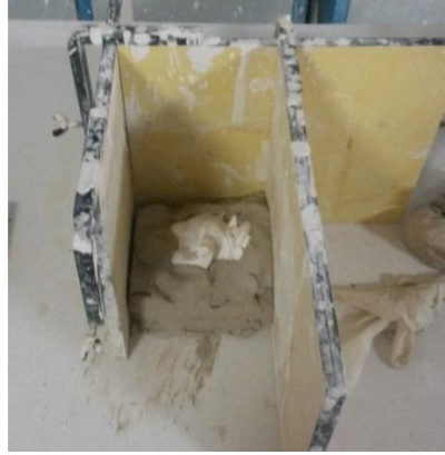
Görsel 3. 12. Refrakter kalıp karışımının dökümü için hazırlanması (Murat Paktur fotoğraf arşivi)
