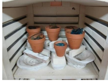
Görsel 1. 19. Potalı akıtma döküm tekniğinde seramik saksıların pota olarak kullanımı ( https://www.dicast.co.nz/news/all/32 )
