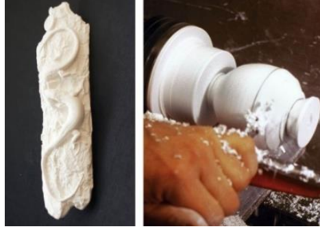
Görsel 1. 29. El ile şekillendirilmiş alçı model (sol), alçı tornada şekillendirilen alçı model (sağ) ( http://shop.italianartcenter.ca/product/fighting-lizards-plaster/ ) ( http://www.mehlmandesign.com/ceramic-glass/blog-detail/turning-plaster-on-the-lathe/ )
