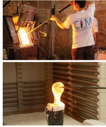
Görsel 1. 25. Sıcak cam ergitme fırını ile fırın içerisinde kalıba döküm yöntemi (Murat Paktur fotoğraf arşivi)
