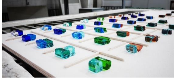
Görsel 3. 4. Deneme camlarının fırın dizilimi detayı (Murat Paktur fotoğraf arşivi)
