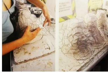
Görsel 1. 6. Refrakter kalıp üzerine tel sarma aşaması (Thwaites, 2011, s. 69)
