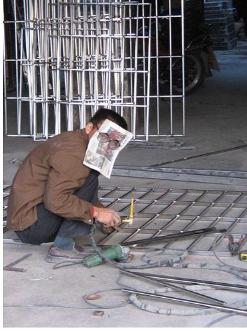
Şekil 3.1. Güvensiz davranışlar - Kaynak yaparken gözlük kullanımında yanlış bir uygulama
