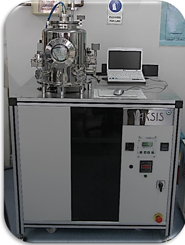
Görsel 3.2. VAKSİS PVD Handy-MT/101T model metal buharlaştırma sistemi
