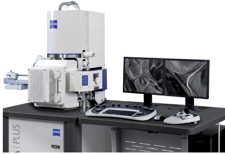
Görsel 2.2. ZEISS ULTRA PLUS model yüksek çözünürlüklü FESEM cihazı Kaynak: [83]
