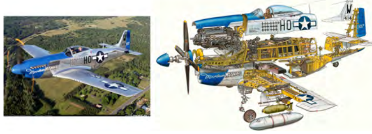
Görsel 1.44. Hans Jenssen'in patlak perspektif ile çizdiği Mustang uçak Kaynak: http://www.hansjenssen.co.uk/cross-sections (Erişim tarihi: 28 Temmuz 2016)
