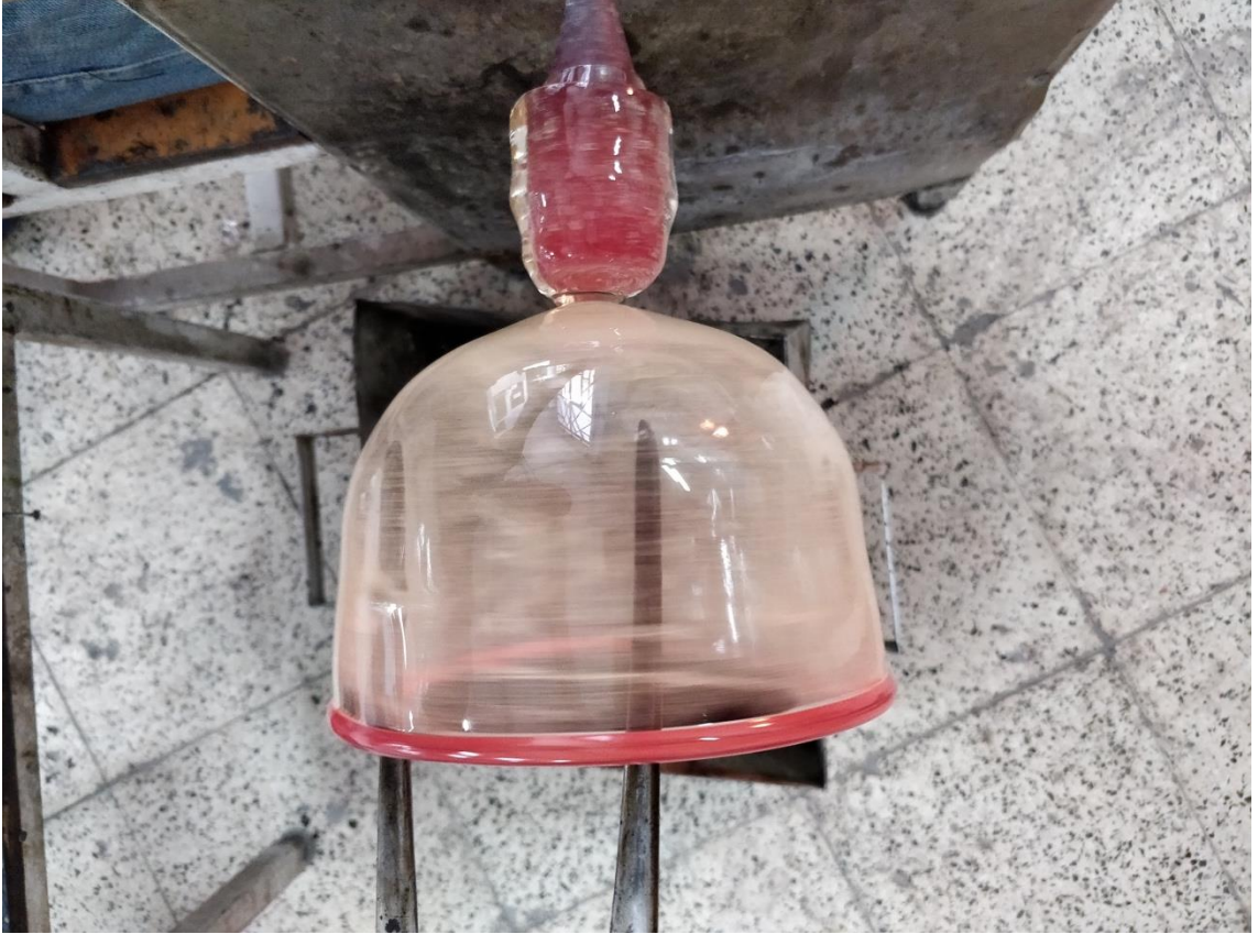
Görsel 5.15. Noble piposundaki kâse formun boğma maşası ile ağız açma işlemi (Fotoğraf: Ufuk Ramazan Akbey)
