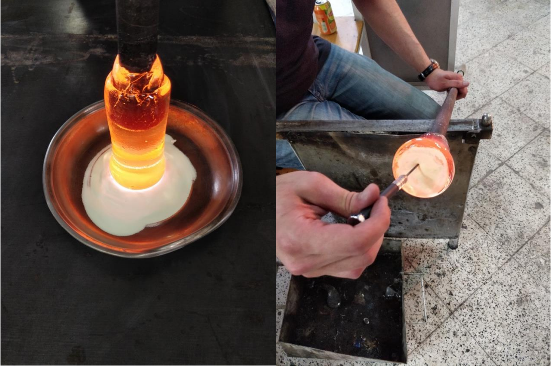
Görsel 5.19. Fosforesans pigment ile kâğıt ağırlığı yapılışı (Fotoğraf: Ufuk Ramazan Akbey)
