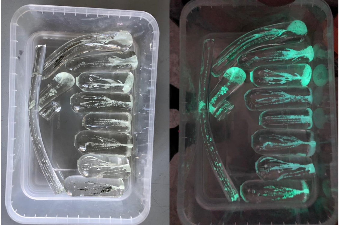
Görsel 5.28. Fosforesans dokulu kristal cam parçaları (Fotoğraf: Ufuk Ramazan Akbey)
