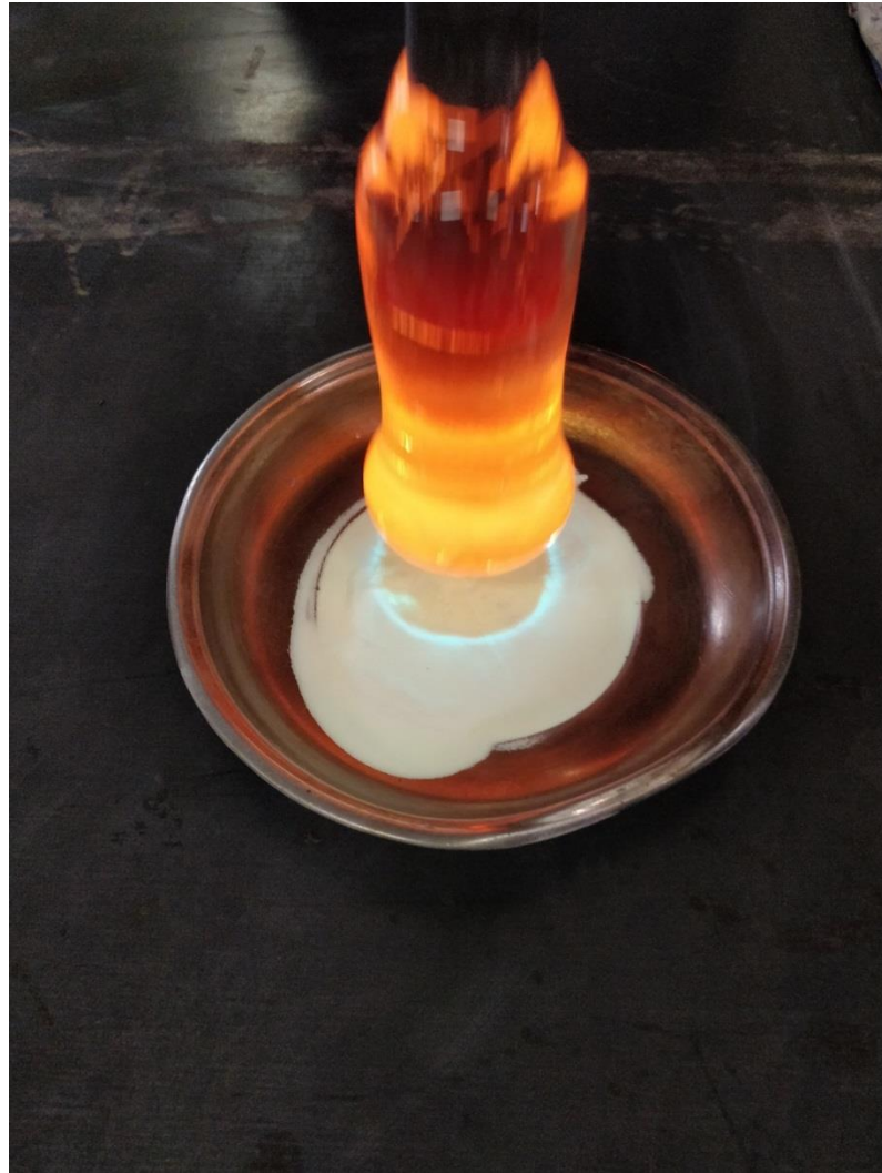
Görsel 5.21. Silindir formun uç kısmı fosforesans pigment kaplanması (Fotoğraf: Ufuk Ramazan Akbey)
