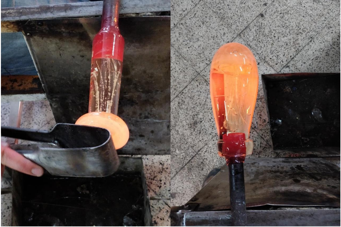
Görsel 5.23. Denizanası kafa kısmı eklenmesi ve şeffaf cam sarılması (Fotoğraf: Ufuk Ramazan Akbey)
