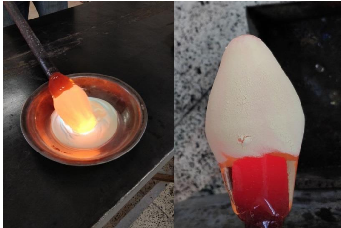
Görsel 5.16. Fosforesans pigment kaplanan sıcak cam yüzeyi (Fotoğraf: Ufuk Ramazan Akbey)
