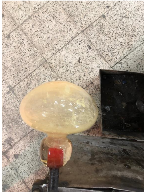
Görsel 5.14. Fosforesans kaplı cam balonuna şekil verilmesi (Fotoğraf: Ufuk Ramazan Akbey)
