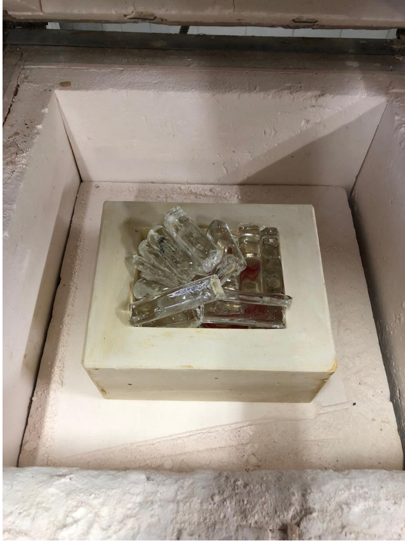
Görsel 5.31. Kalıbın kristal cam parçaları ile doldurularak fırına yerleştirilmesi (Fotoğraf: Ufuk Ramazan Akbey)
