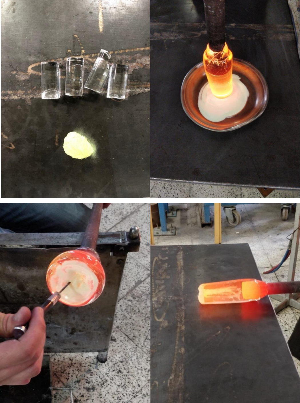
Görsel 5.27. Kristal cam parçalarına fosforesans pigmentlerin uygulanma aşamaları (Fotoğraf: Ufuk Ramazan Akbey)
