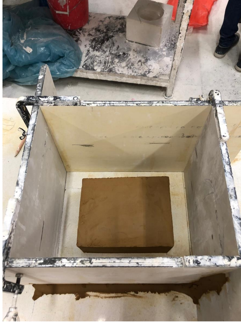
Görsel 5.29. Kalıp malzemesi dökülmeye hazır çamur model (Fotoğraf: Ufuk Ramazan Akbey)
