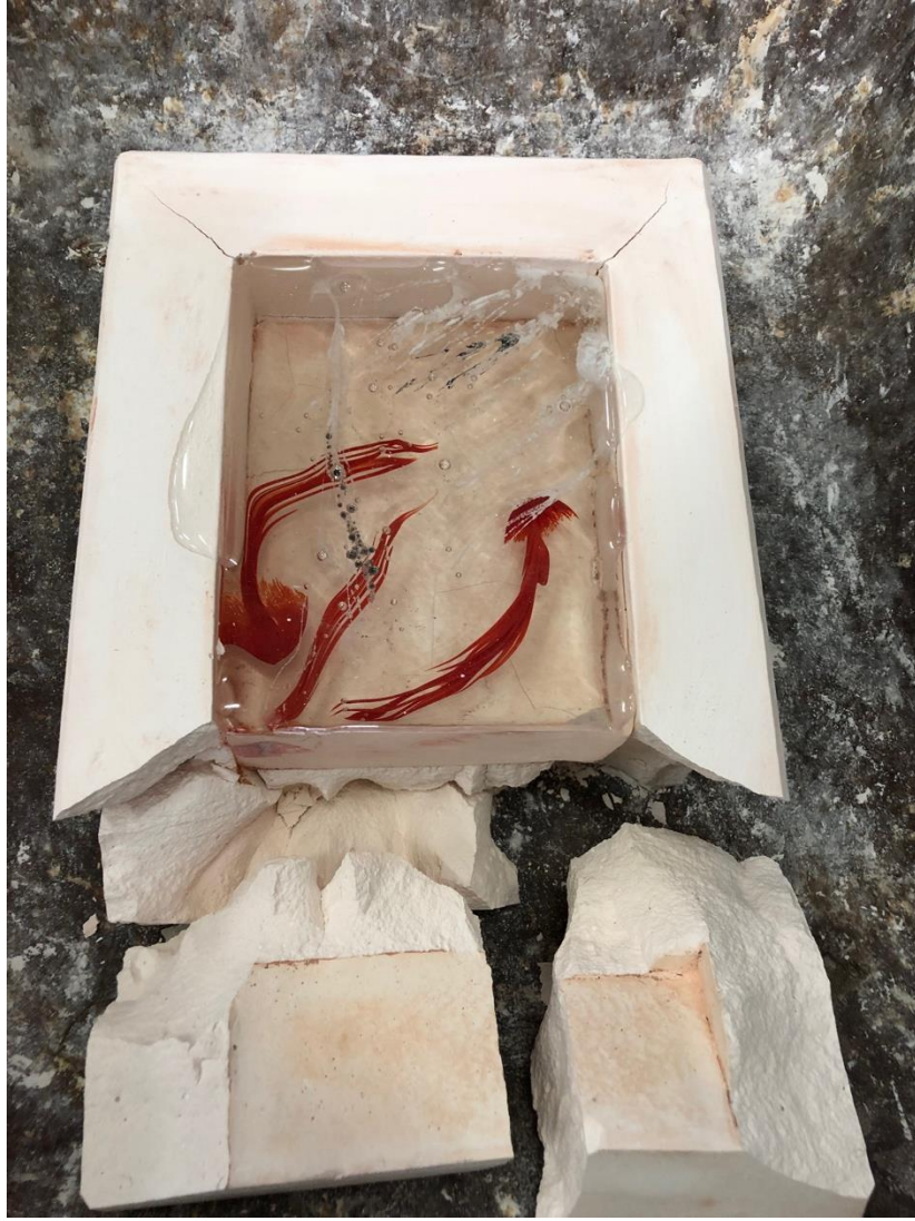
Görsel 5.32. Oda sıcaklığında kalıp malzemedan ayrılan cam (Fotoğraf: Ufuk Ramazan Akbey)
