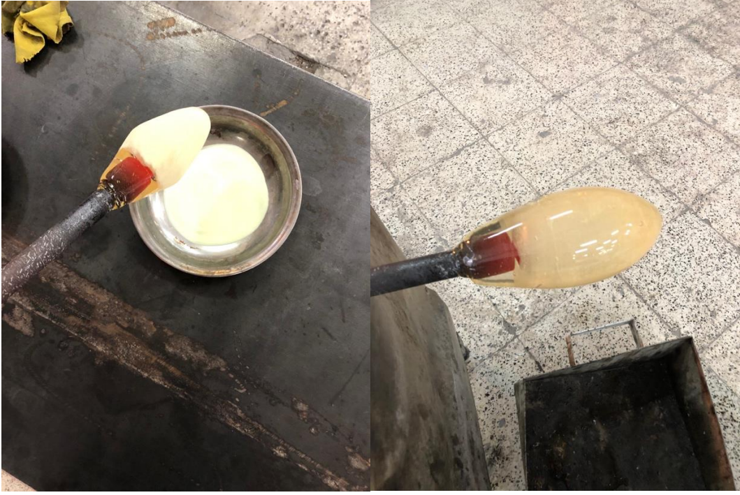
Görsel 5.13. Fosforesans pigmentlerin sıcak cam yüzeyine kaplanması (Fotoğraf: Ufuk Ramazan Akbey)
