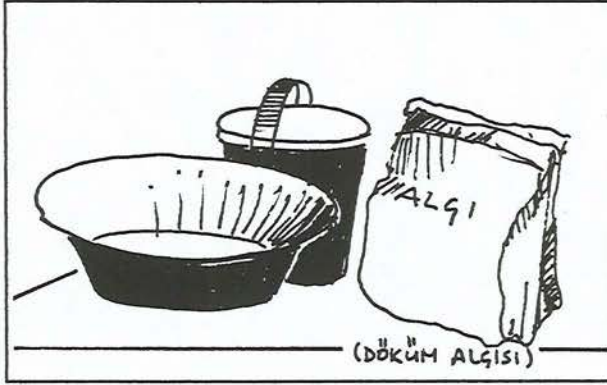
Şekil 42 Camları tutacak olan alçı iskeletin oluşması için gerekli olan alçı, su ve geniş bir kab,
