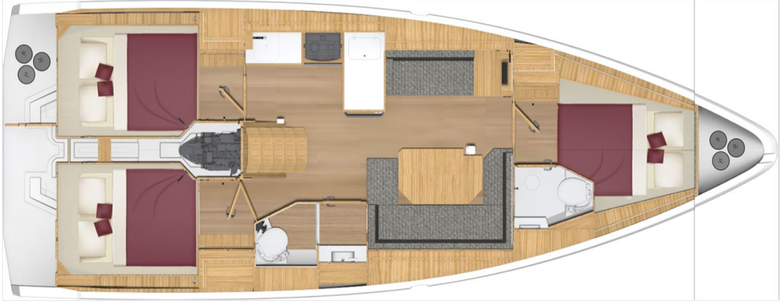
Şekil 4. 7. Bavaria Yachts C38 (11 mt), Ortak yaşam alanlarının orta, kamaraların ise baş ve kıç taraflarında konumlandırıldığı yerleşim planı ( http-77 ).
