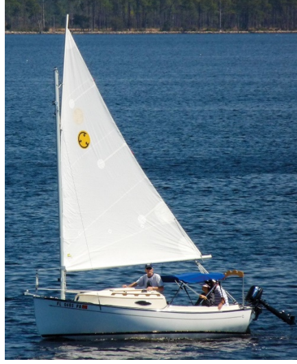
Görsel 2. 8. Seyir halinde olan kat (cat) arma donanımlı bir yelkenli ( http-48 ).
