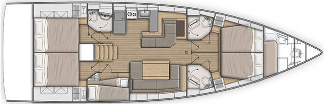
Şekil 4. 15. Beneteau Oceanis 51.1 Modeli, kıç ve baş kısımlarına merkez hattına paralel ve yakın olarak yerleştirilmiş kamara bölümleri ve yataklar ( http-103 ).
