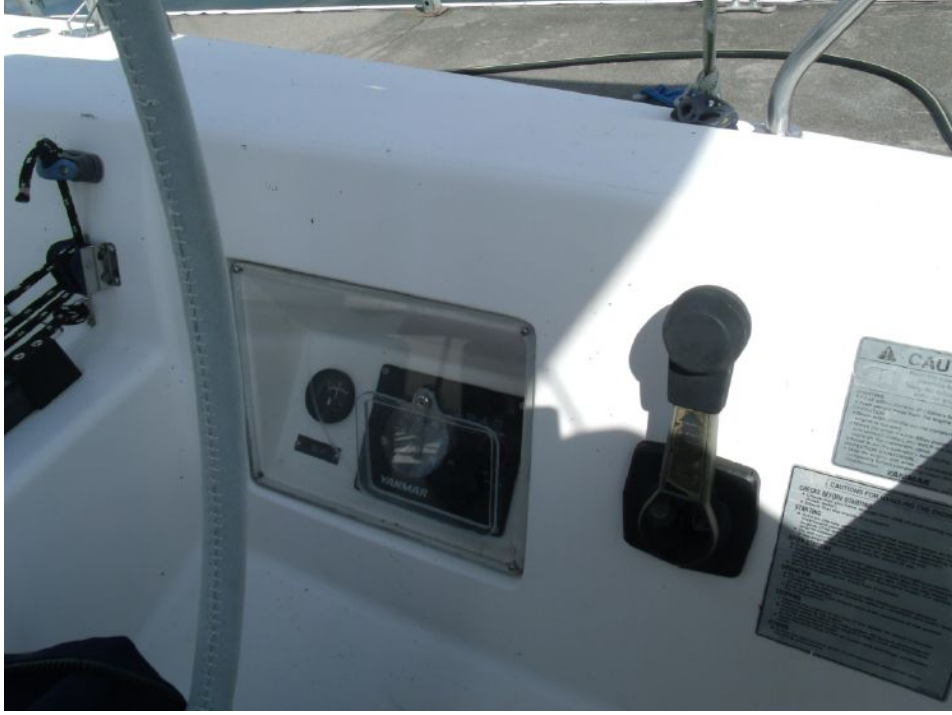
Görsel 4. 49. J Boats, J35, dümen yanına konumlandırılmış motor gösterge ve kontrol paneli ( http-116 ).
