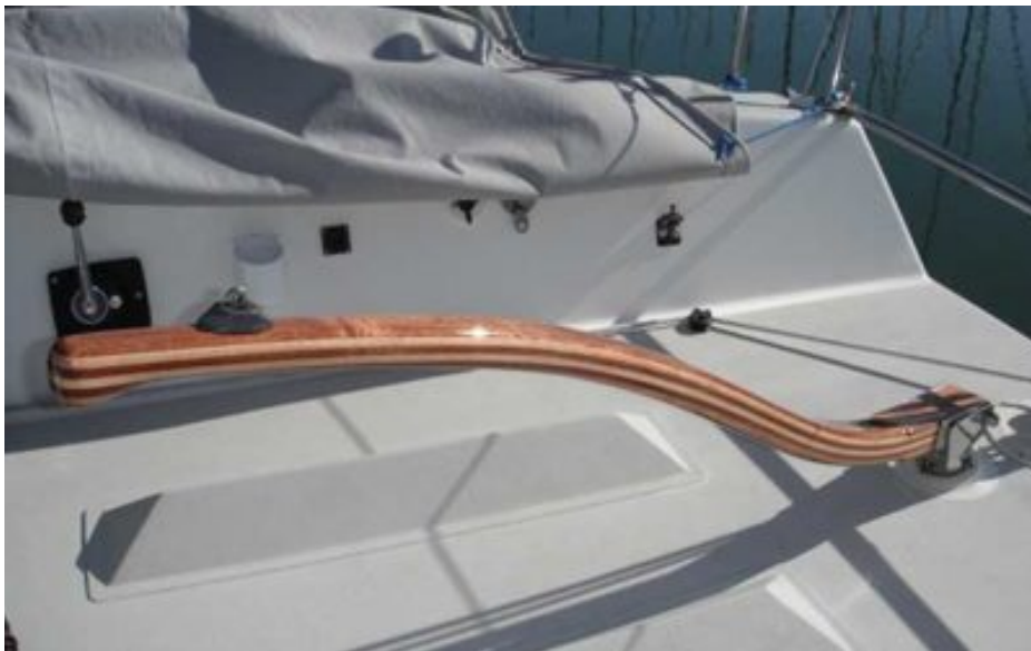
Görsel 4. 46. Bir deniz aracı kıç tarafında uygulanmış yeke dümen sistemi ( http-113 ).
