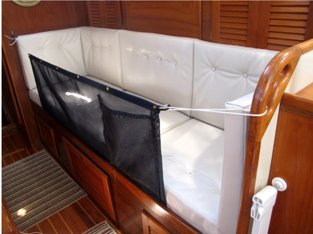
Görsel 4. 38. Yelkenli deniz aracında ortak alanda yatmak için kullanılan yalpa bezi ( http-104 ).
