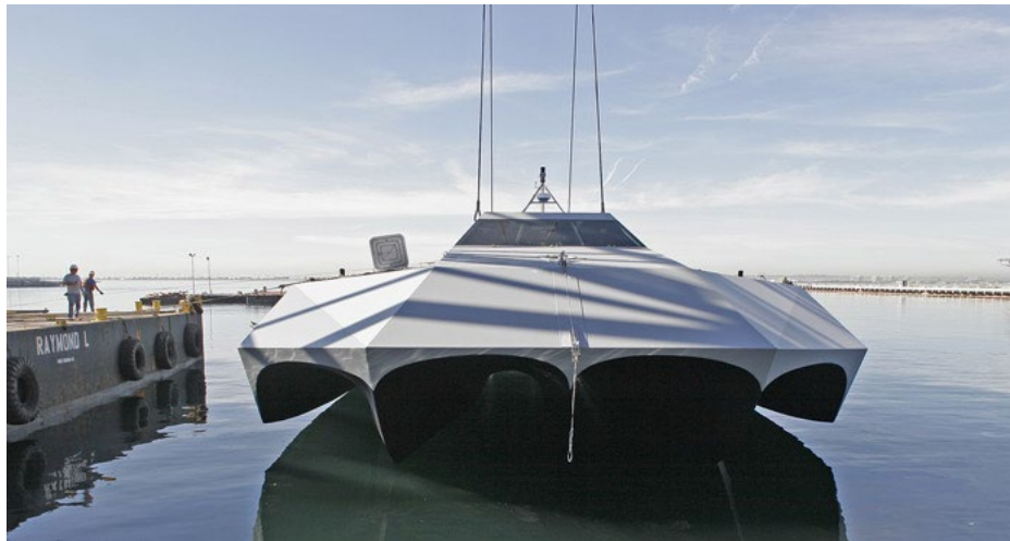
Görsel 2. 6. Amerika donanmasının geliştirdiğı USS M80-Stiletto, yüksek hızlı pentamaran ( http-42 ).
