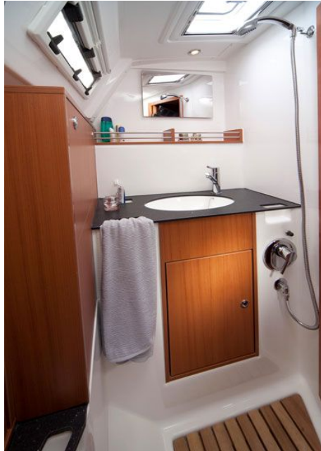
Görsel 4. 45. Lomboz ve heç ile aydınlatma ve havalandırması sağlanan bir ıslak hacim (http-112).
