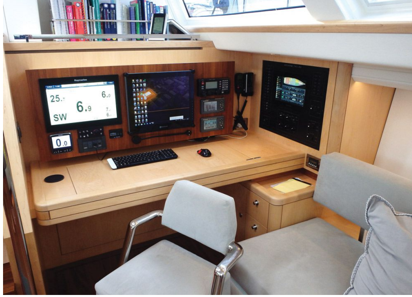
Görsel 4. 57. Navigasyon ünitesinde harita masası ve oturma birimi bulunan deniz aracı ( http-127 ).
