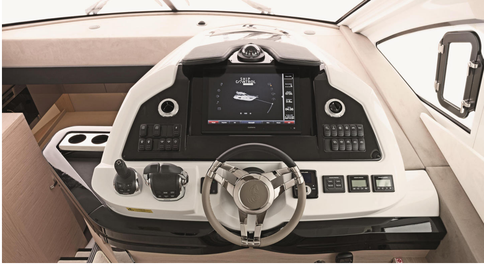
Görsel 4. 54. Beneteau Yachts, Gran Turismo 50 Sportfly modeli, dümen, motor kontrolleri, yardımcı kontroller, pusula, navigasyon ve telsiz ekipman ve cihazlarını içeren dümen istasyonu ( http-123 ).
