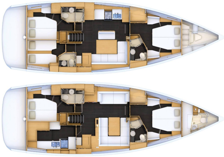
Şekil 4. 8. Jeanneau Yachts 54 modeli için Philippe Briand tarafından tasarlanan U ve L oturma birimli iki alternatif iç mekân tasarımı ( http-83 ).
