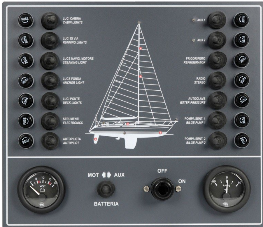
Görsel 4. 59. Bir yelkenli deniz aracı elektriksel donanım kontrol ve gösterge paneli ( http-129 )
