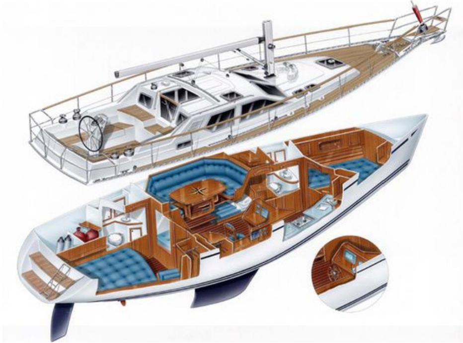
Şekil 2. 9. Motor yelken deniz aracında iç mekân ve dümen dolaplarının gösterimi ( http-64 ).
