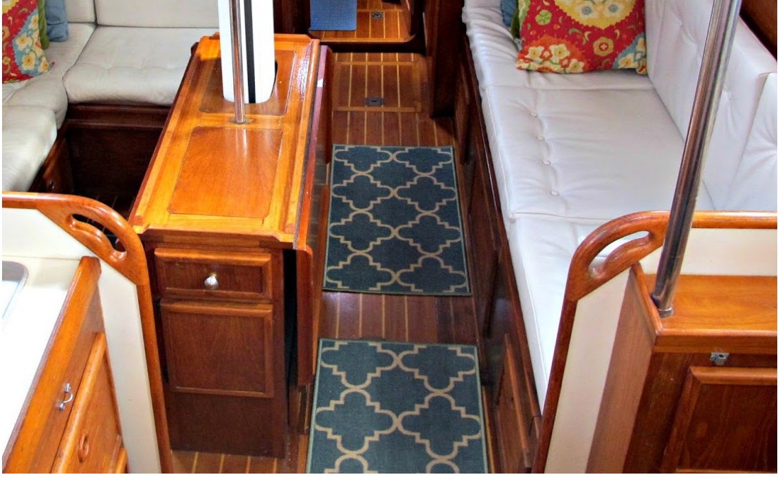
Görsel 4. 18. Mekânsal bölücü köşelerinin tutamak olarak tasarlandığı bir örnek ( http-81 ).
