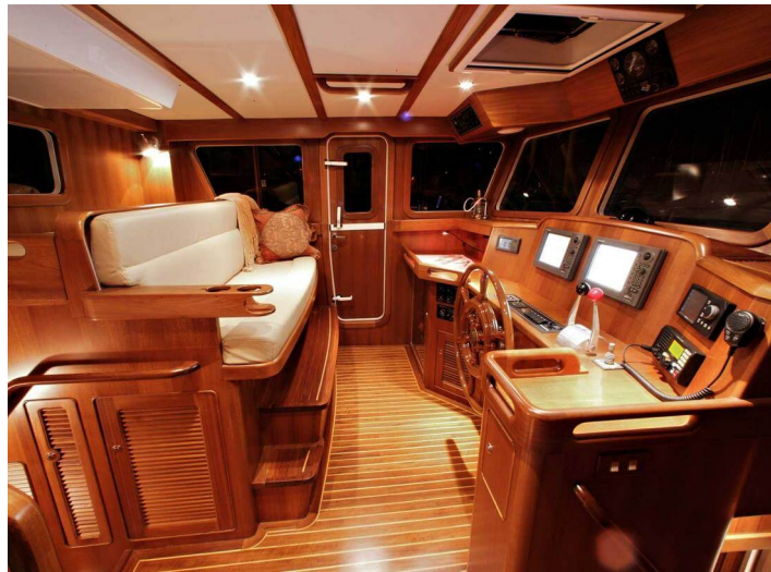
Görsel 4. 60. Selene Yachts, Selene 45 modeli, Kaptan köşkü olarak özelleşmiş bir iç mekân, harita masası (Solda), dümen istasyonu (Ortada) ve telsizin yer aldığı iletişim istasyonundan (Sağda) oluşan parça konsol ( http-131 ).
