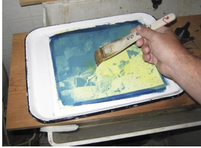
Görsel 3.28. Baskı Yüzeyinin Emülsiyon ile Kaplanması
