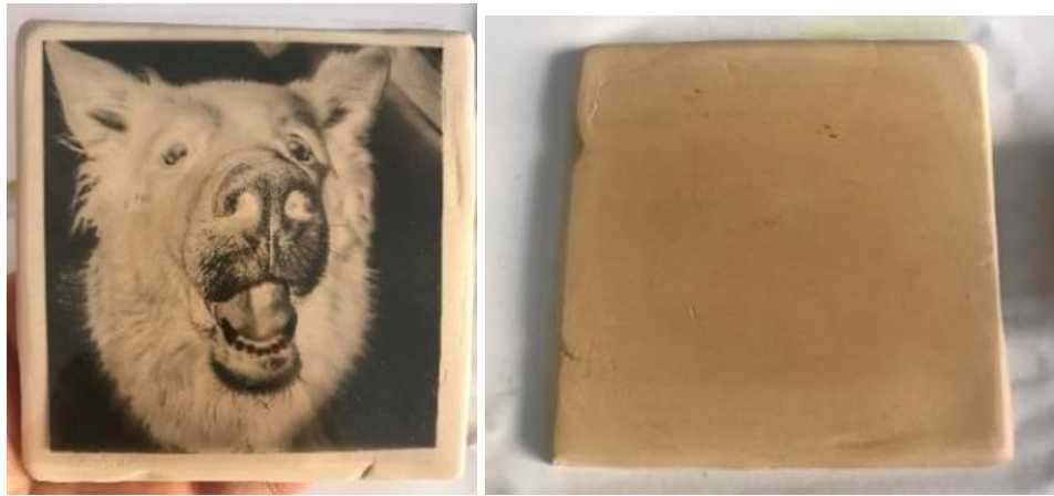
Görsel 4.1. Pozlama sonrası sonuç elde edilemeyen plaka örneği (Araştırmacı Arşivi)
