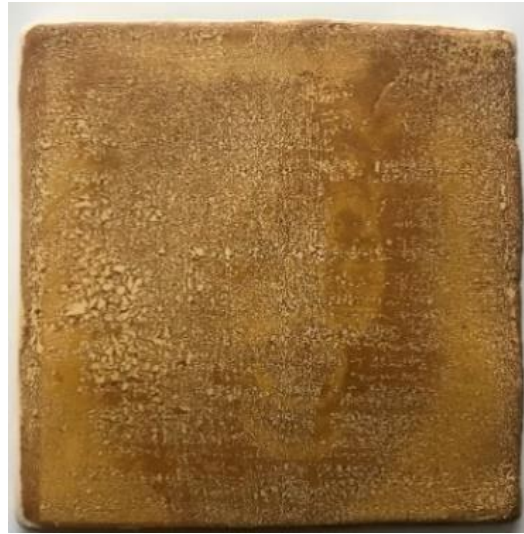
Görsel 4.80. Yıkama aşamasında yaşanan deformasyon (Araştırmacı Arşivi)
