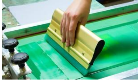
Görsel 2.41. Rakle ile boya yayılırken bir görsel ( https://www.refsan.com.tr/serigrafi-5857 18.04.2020)
