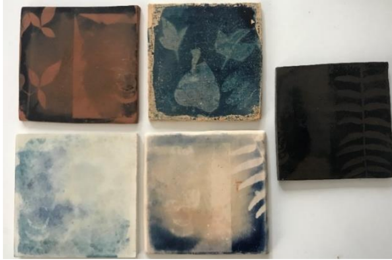
Görsel 4.36. Glioksal ile sertleştirilmiş jelatinli plakaların Cyanotype pozlama sonuçları (Araştırmacı Arşivi)
