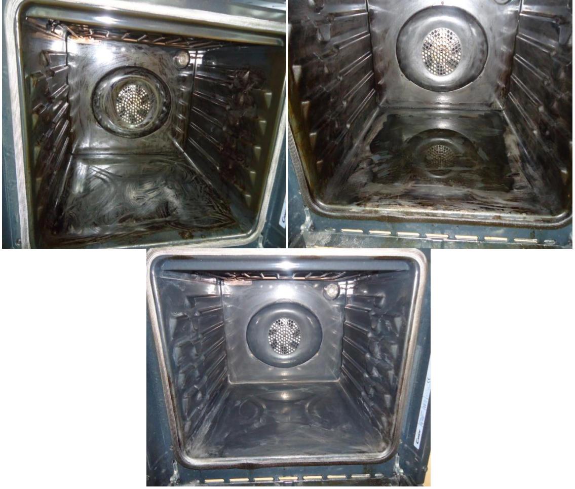
Şekil 9.30. Su ortamında pirolitik çevrim a) Kirletilmiş hali, b) Fırının tabanına konulan su, c) Pirolitik çevrim sonrası.
