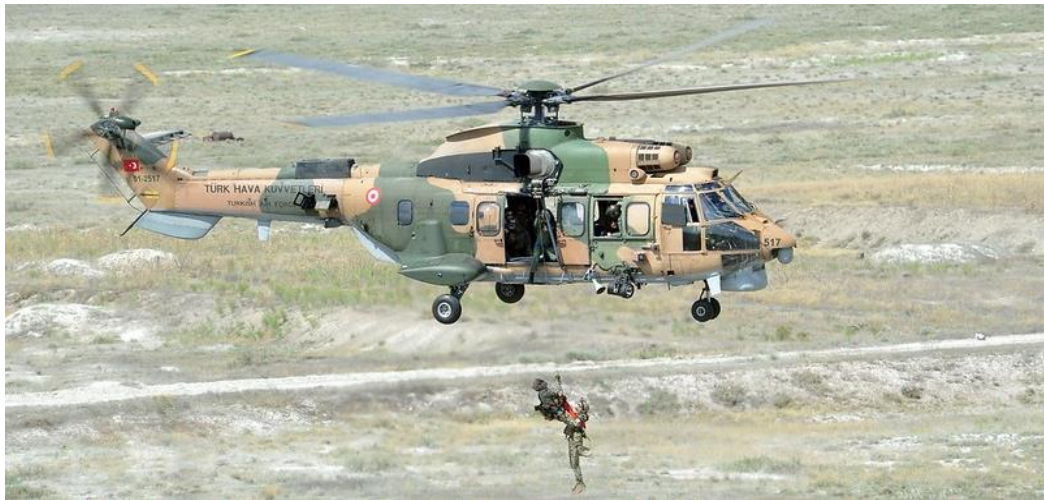
Görsel 2.4 Türk Silahlı Kuvvetlerine Ait AS-532 Cougar Arama Kurtarma Helikopterinin Hover Pozisyonunda Vinç ile Kazazede Tahliyesi.
