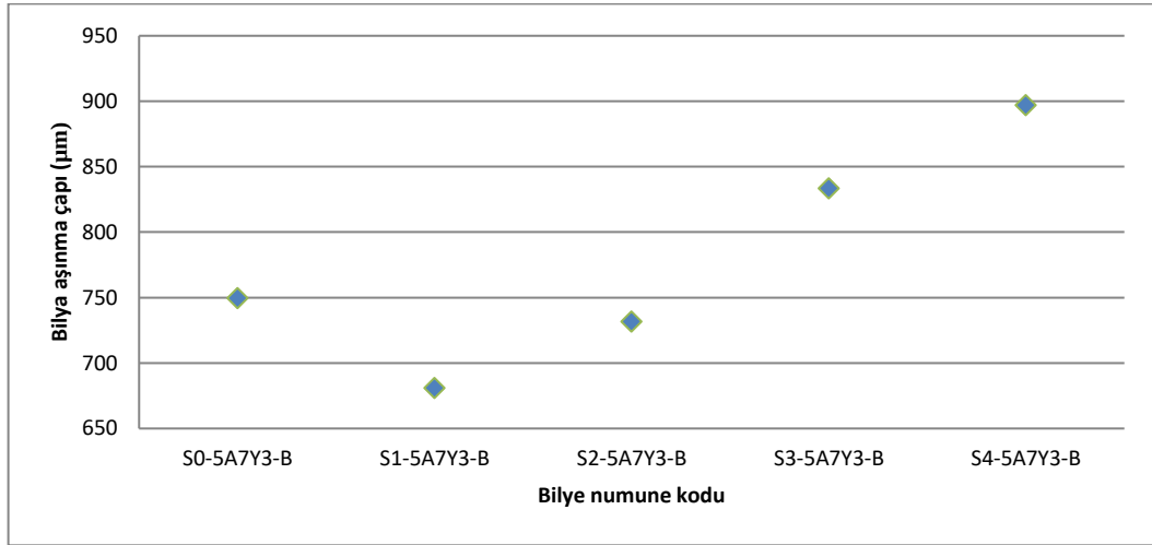
Şekil 6.110. Aşınma testinde kullanılan bilyelerin aşınma çapı
