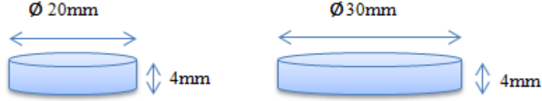
řekil 5.3. 20 ve 30mm apında ve 4mm kalınlında hazırlanan numuneler
