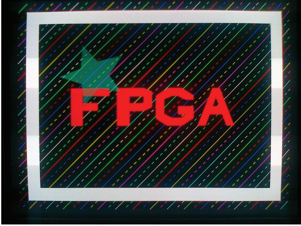
Şekil 5.3. Şekil 5.2’de görülen yıldızın saydamlaştırılıp, arka plan üzerindeki başka bir bölgeye taşınması ile elde edilen ekran görüntüsü
