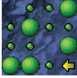
Şekil 3.15. Maske ile AND'lenen arka planın nesne ile OR'lanması ve son görüntü
