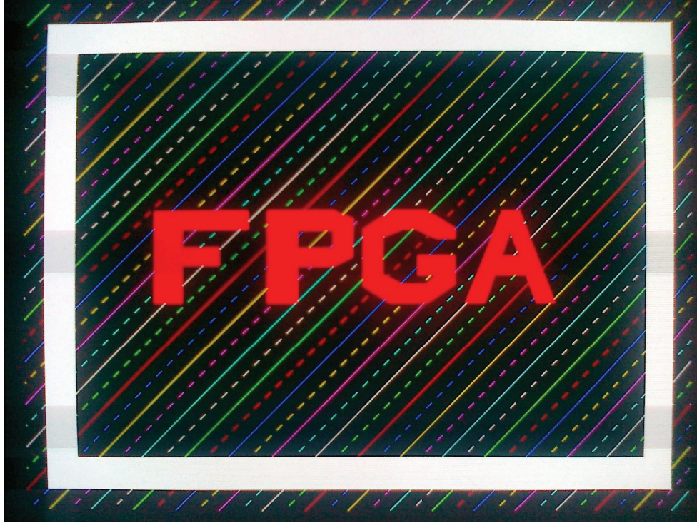
Şekil 5.2. Bresenham metodu ile çizdirilen kesikli ve sürekli çizgilerin, Tekst API ile yazdırılan karakterlerin ve BitBLT ile boyanan alanların görülebildiği örnek (arka plan) ekran görüntüsü
