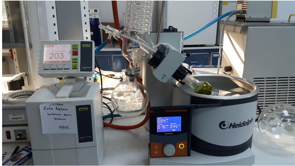
Görsel 3.9. Rotavaporda çözücünün uçurulması işlemi
