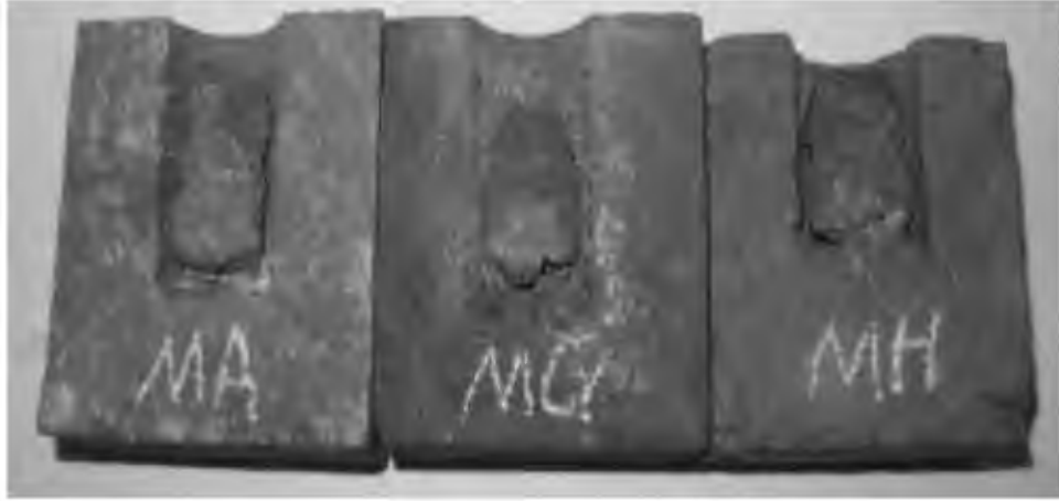
Şekil 1.12. MA, MCr ve MH malzemelerinin korozyon dayanımları [20]
