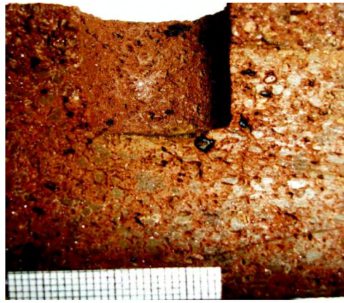
Şekil 3.277. Kare prizma şeklinde hazırlanarak korozyon testleri yapılan M-%5H-%5ZrSiO 4 refrakter malzeme (Ölçek: 1 mm)
