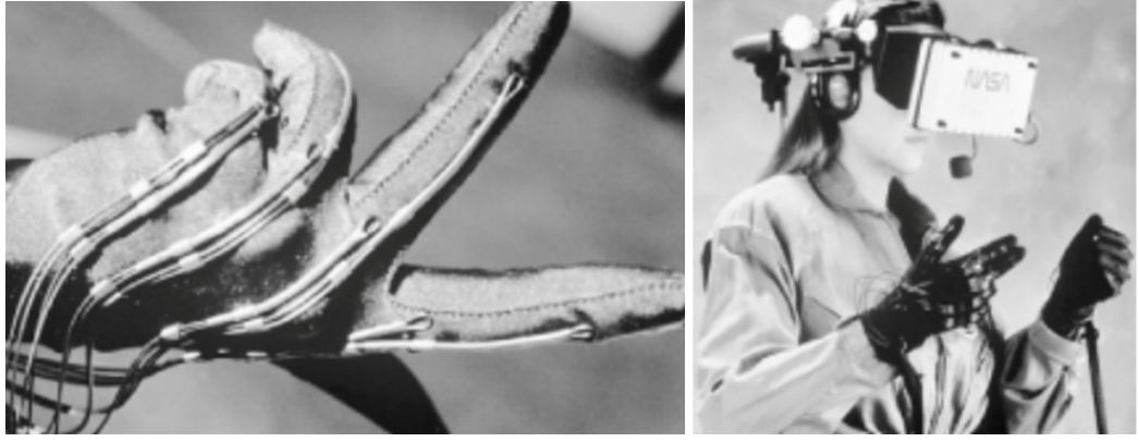
Görsel 2.17 Kablolu Sanal Gerçeklik Denetimleri, Başlık ve Eldiven, (1994), NASA, Kaynak: Lovejoy, 2004, s. 327
