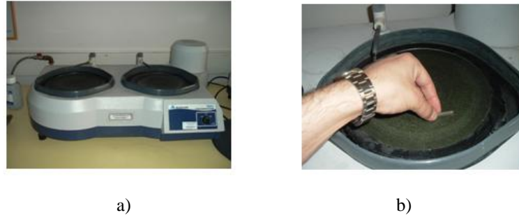
Şekil 4.6. a) Numune parlatma cihazı, b) Numune yüzeylerinin parlatılması işlemi
