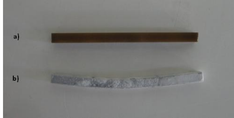
Şekil 5.36. a) Sinterlenmiş 25A SiAlON seramiğinin, b) Sürünmüş 25A SiAlON seramiğinin görünümü
