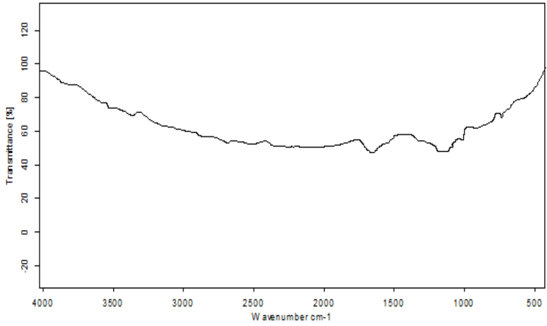
Şekil 6.9. Azotlu Ortamda 550 °C’de Elde Edilen Aktif Karbonun FT-IR Spektrumu
