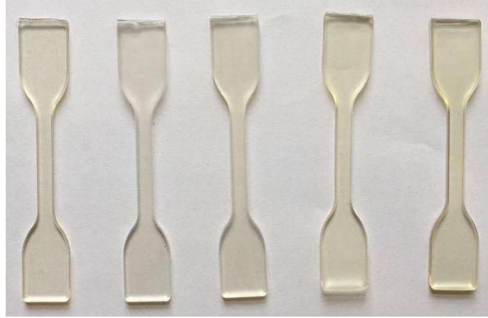
Görsel 3.5. Saf PLA, PLA-(%5, %10, %15, %20) karvakrol numuneleri
