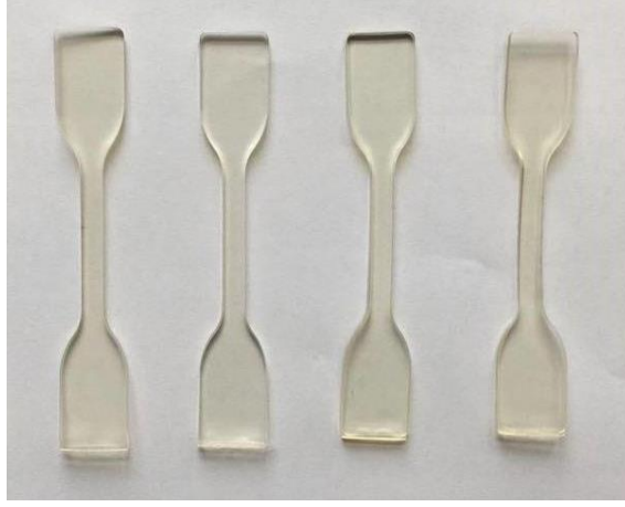
Görsel 3.6. PLA-(%5, %10, %15, %20) karvakrol-(%15) ATBC numuneleri
