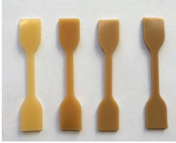
Görsel 3.7. PLA-(%5, %10, %15, %20) polikarvakrol numuneleri
