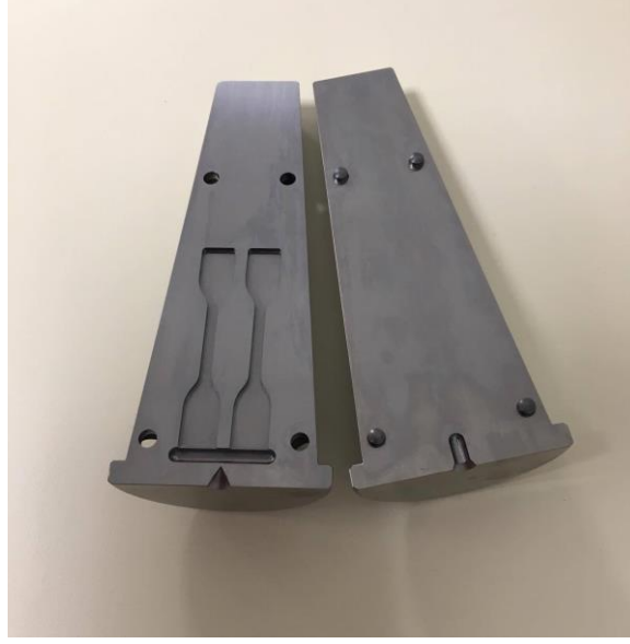
Görsel 3.4. Kompozitlerin Şekillendirildiği Kalıp
