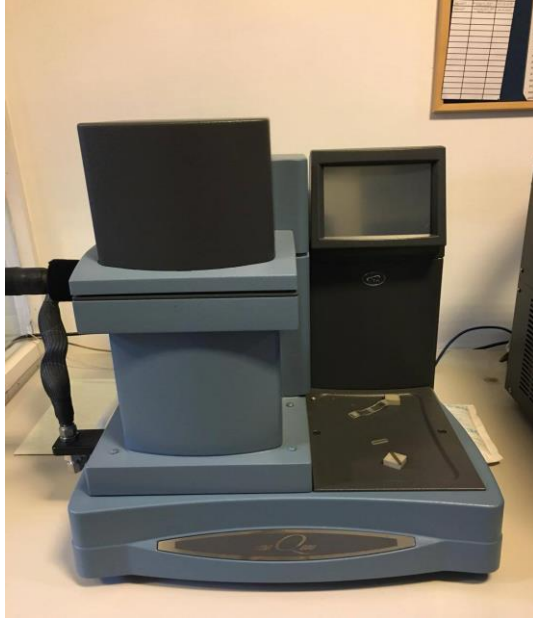
Görsel 3.16. Dinamik Mekanik Analiz Cihazı
