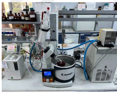
Görsel 3.12. Süzöntülerin rotavaporda (Heidolph) uçurulması işlemi
