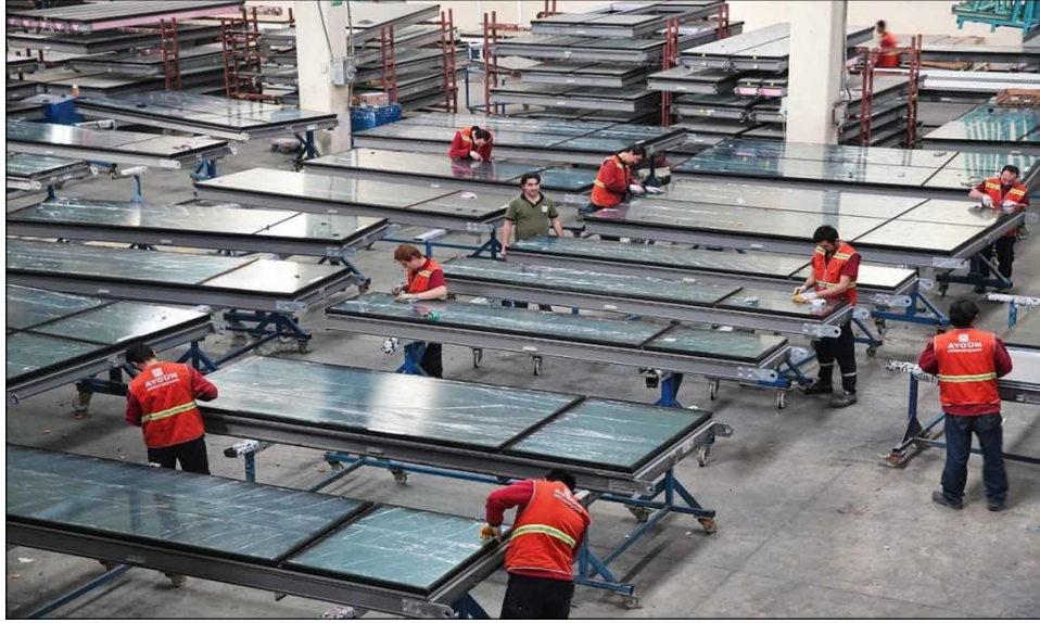
Görsel 2.18. Birleştirilmiş giydirme cephe sisteminin önceden oluşturulmuş birimleri (Metal Yapı, 2012)
