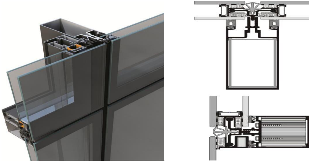
Görsel 2.15. Dört taraflı tipin plan, kesit ve aksonometrik görünümü (Alumil Technic Catalogue, 2011)
