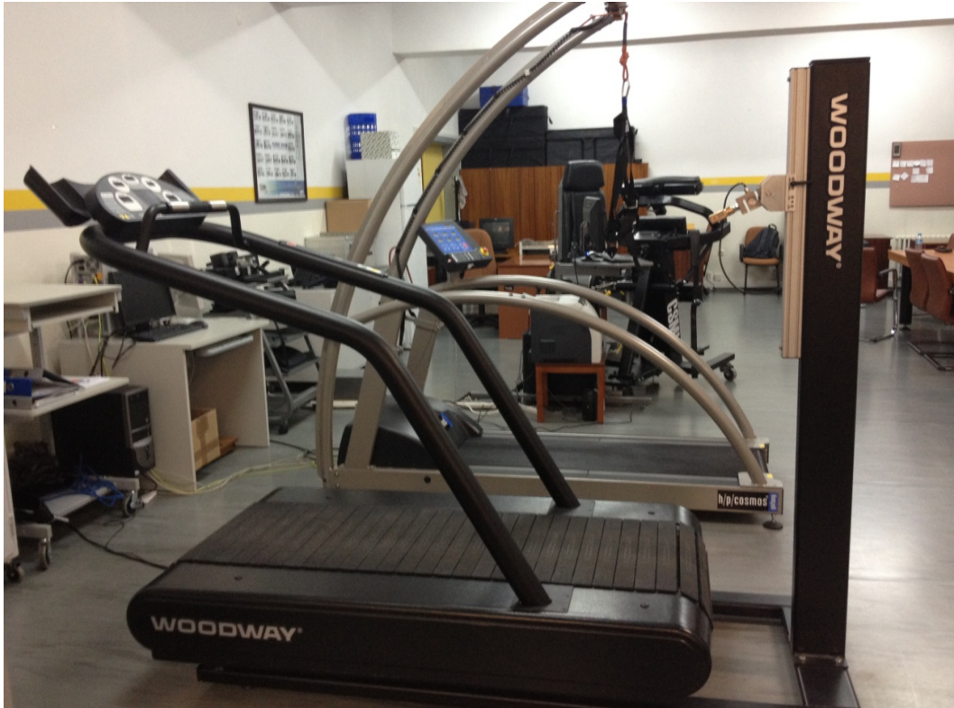
Şekil 14: Kuvvet ölçebilen Motorsuz Koşu Bandı
