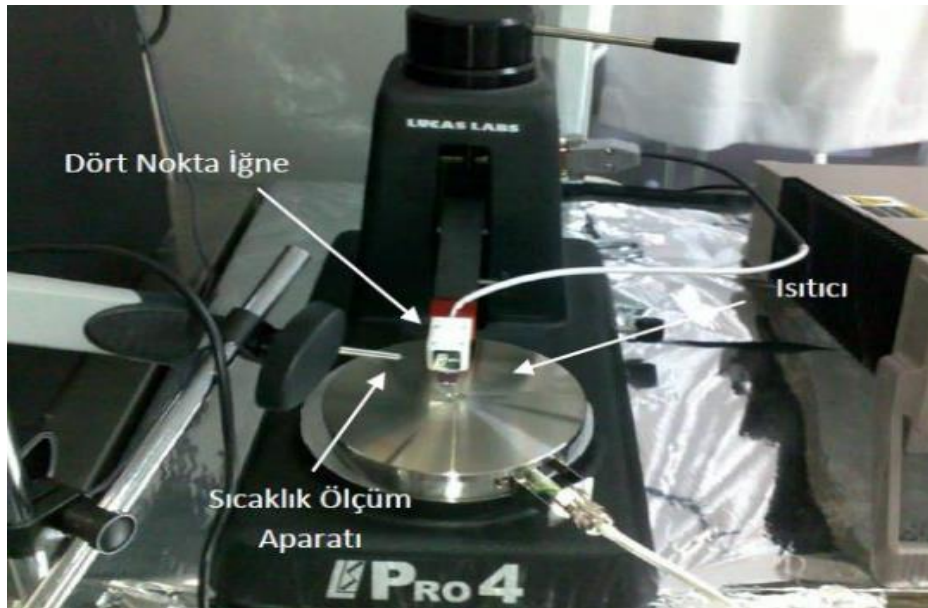
Şekil 4.1. FPP sistemi, sisteme entegre edilen ısıtıcı ve filmin yüzeyindeki sıcaklığı ölçmek için kullanılan sıcaklık ölçüm aparatı
