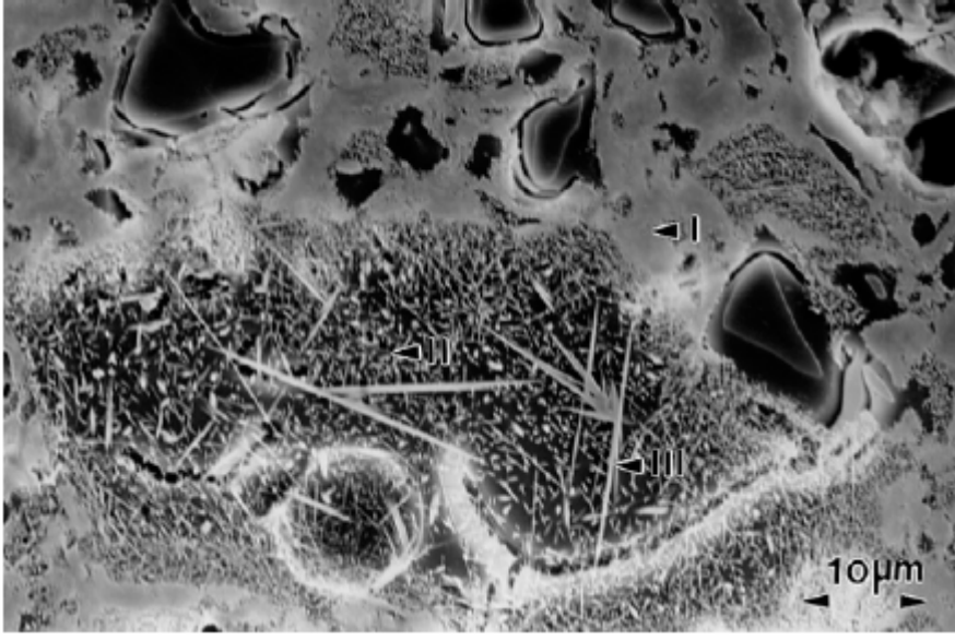
Şekil 2.3. Müllitin 3 tipini içeren Wedwood porseleninin ikincil elektron SEM görüntüsü [8]
