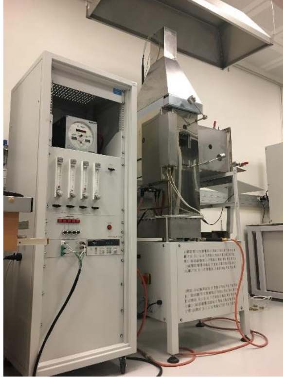
Şekil 2.5. OSU HRR test kabini
