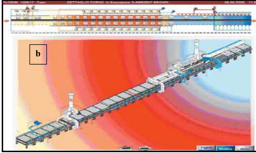
Şekil 1.6. b. Fırın sıcaklık dağılımı [9].
