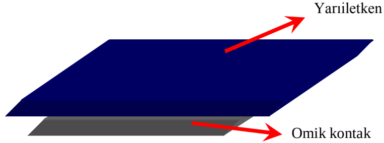
Şekil 2.9. Metal-yarıiletken kontak şematik yapısı
