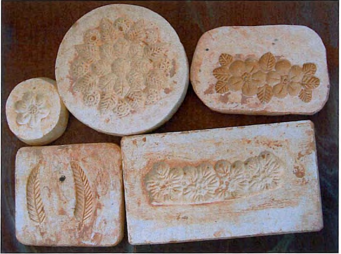
Resim 142: Çanakkale Seramikleri röprodüksiyonunda kullanılan bazı alçı kalp örnekleri
