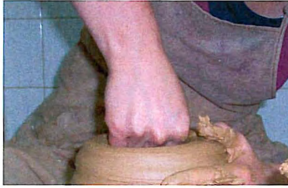
Resim 10: Çamuru yumrukla delme yöntemi (canlandırma)
