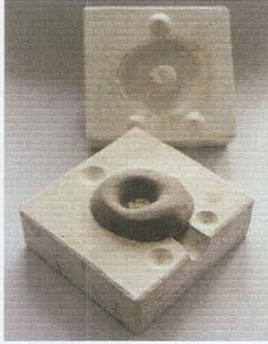
Resim 25 : Döküm Yönteminde Kullanılan Alçı Kalıp (Çamur Model ile) Yapımı.
