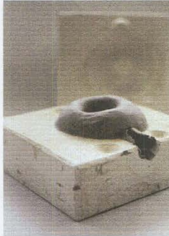
Resim 26 : Alçı Kalıba, Döküm Yöntemiyle Yapılan Şekillendirme
