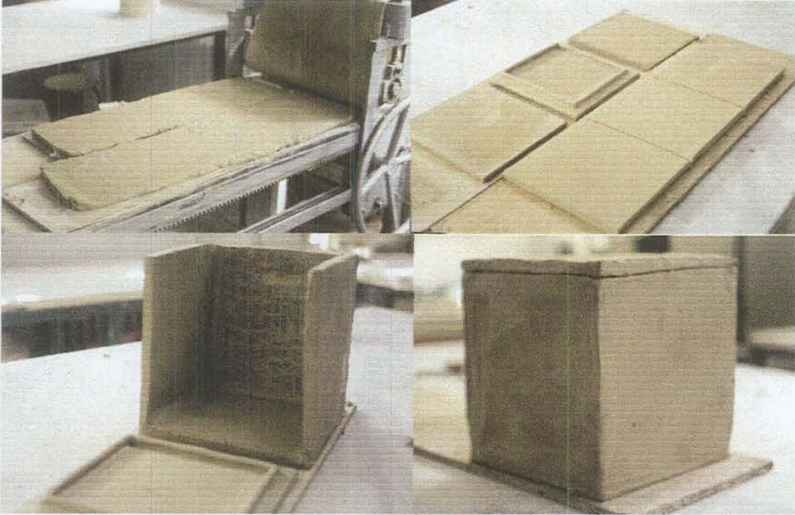
Resim 32 : Sagar Kutusunun Yapım Aşamaları.
