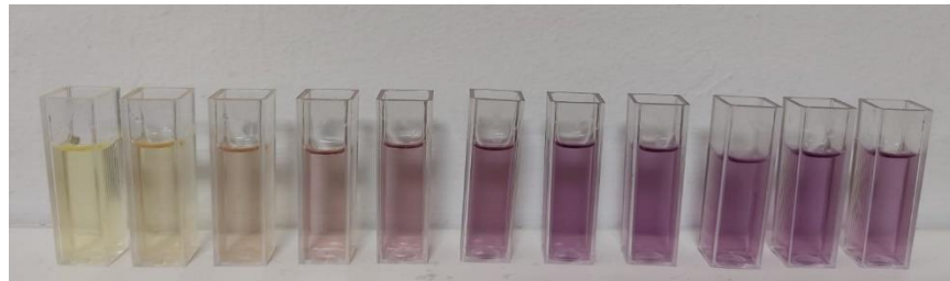
Şekil 4.11. Fungus izolatlarının DPPH çözeltisi ile inkübasyonu sonrası spektrofotometre küvetindeki görünümü
