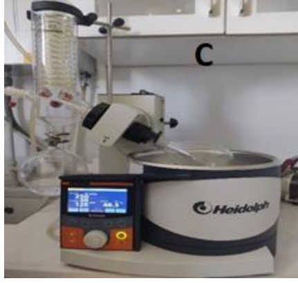
Şekil 4. 12 (A) Antioksidan sıvı besiyerinde 30 gün bekletilen fungus izolatları (B) Fermentasyon sıvısının 1:1 oranda etil asetat ile ekstraksiyonu (C) Rotavaporda organik fazın uçurulması
